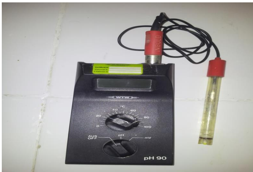
Figure III. 3: Photo du pH mètre.
