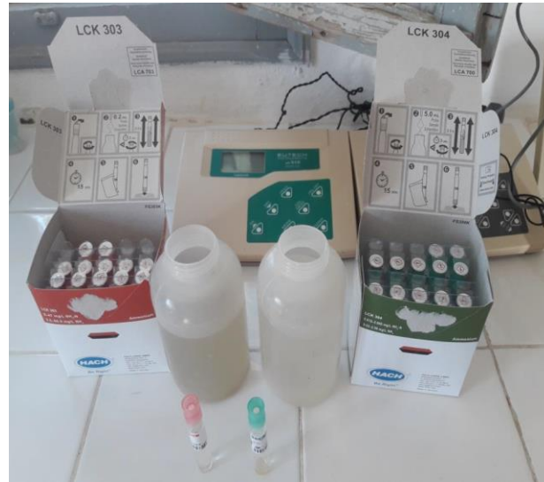
Figure III.11 : Photo représentant la manipulation pour la détermination de \text{NH}_4^+
