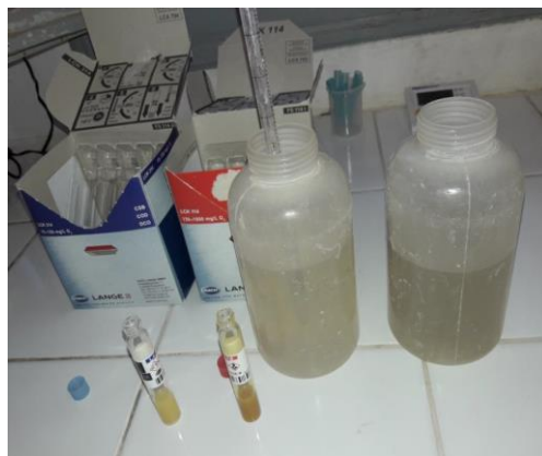
Figure III.8: Photo représentant l'analyse de la DCO.
