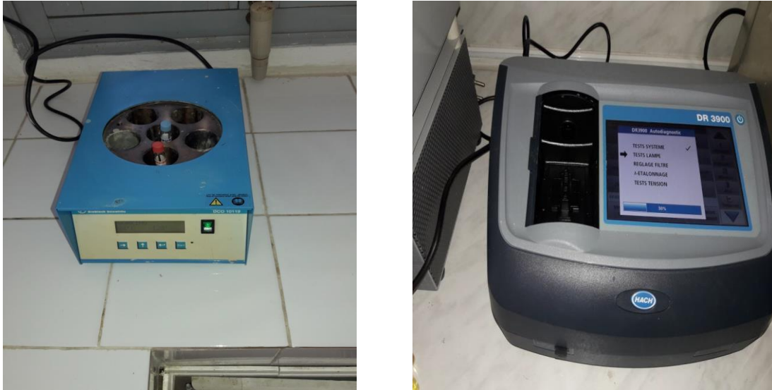
Figure III.7 : Réacteur utilisée pour la mesure de la DCO à gauche et un Spectrophotomètre à droite
