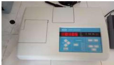
*Figure III.3: Turbidimètre (HACH 2100N).*
