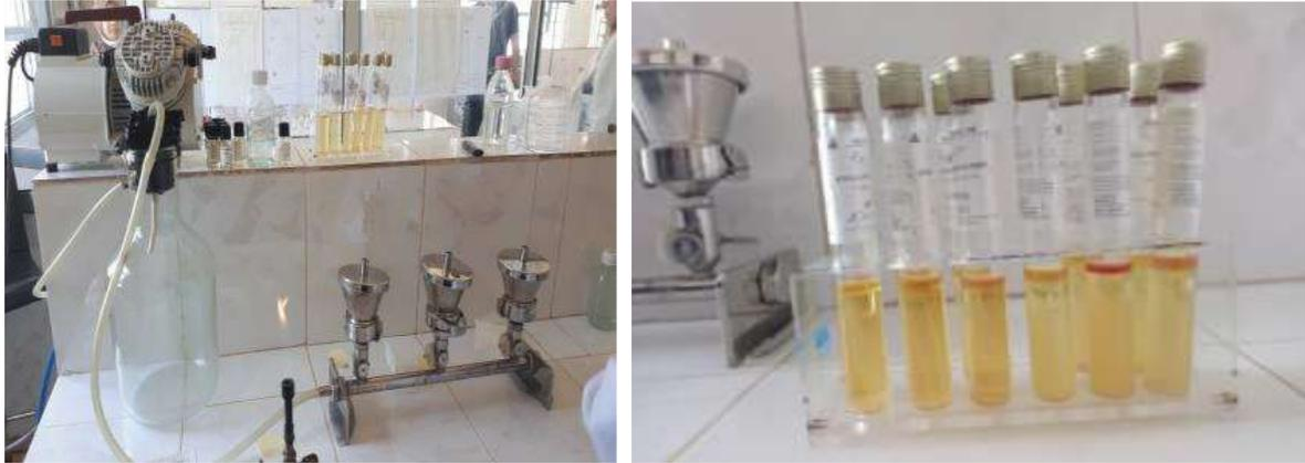
**Figure III.6:** La rampe de la filtration pour dénombrement des coliformes totaux et fécaux
