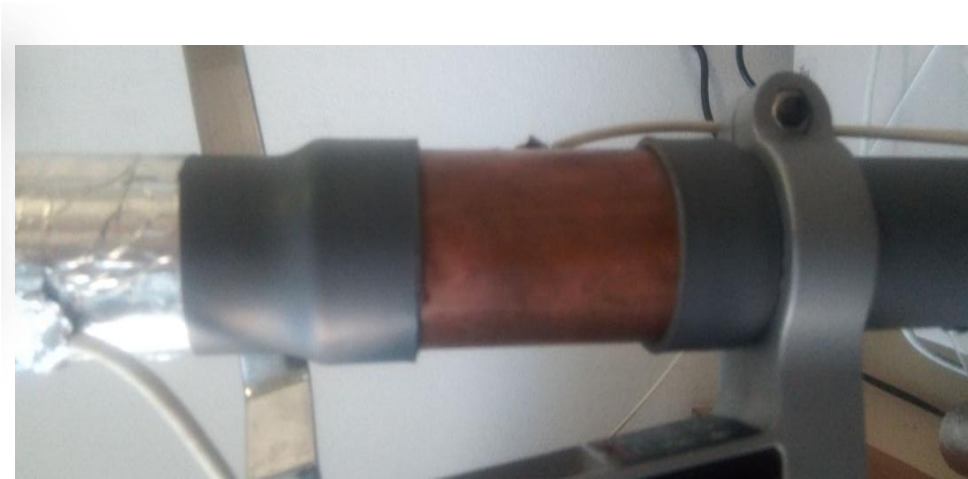
Figure II.6 : l'électrode de couronne coaxial :a) schémas, b) Photographie.
