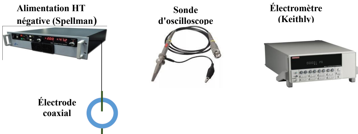
Figure II.3 : Installation expérimentale pour la caractérisation électrique de la décharge couronne coaxiale fil-cylindre. [2]
