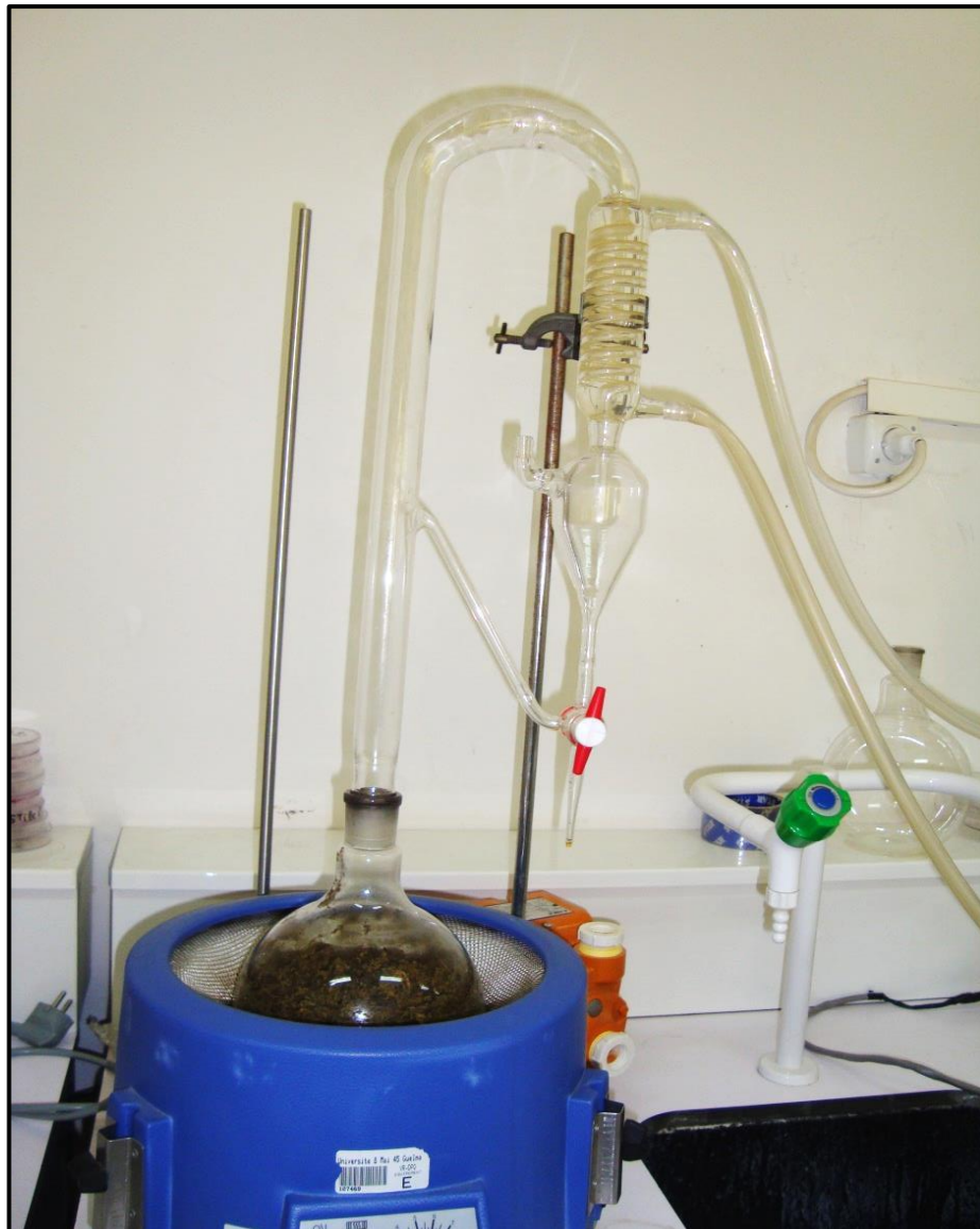
Figure 08 : Photographie du montage de type Clevenger utilisé pour l'extraction des huiles essentielles (Photo personnelle)
