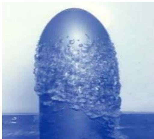
**Figure III.12 :** Cavitation à poches sur un engin sous-marin
