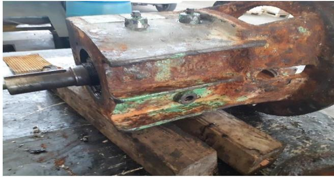
**Figure III.2 :** Dégradation au niveau du corps d'une pompe 502-P-001A
