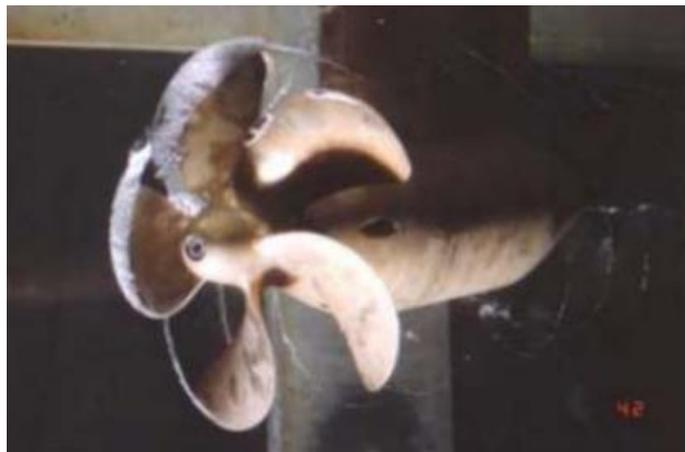
**Figure III.14** : Cavitation à lames sur une pale d'hélice
