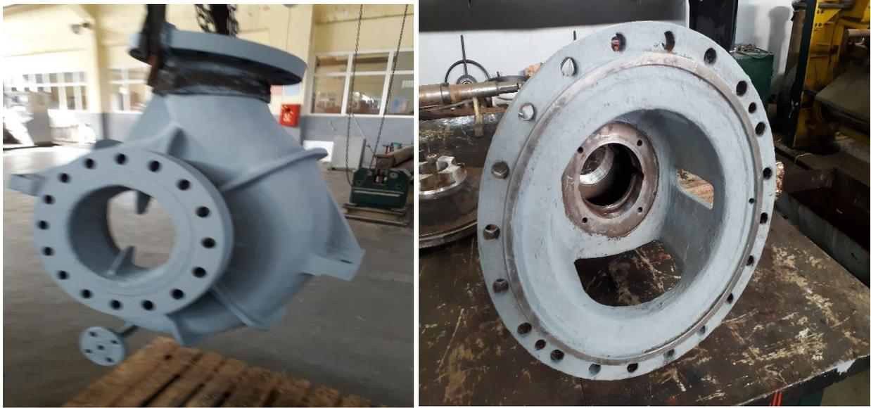
**Figure III.7 :** Application d'une peinture anti corrosion.
