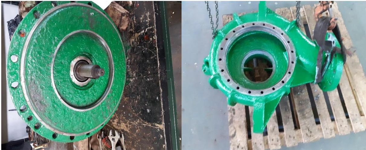
**Figure III.8 :** Application de peinture de finition à base d'époxy couleur RAL6028- vert pin.
