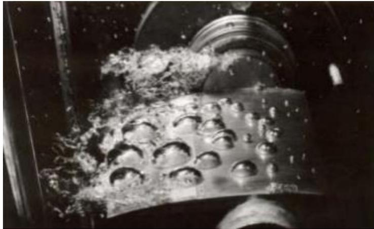
**Figure III.11:** Cavitation à bulles séparées
