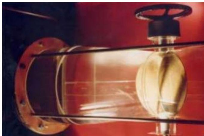
**Figure III.16 :** Cavitation de mélange en aval d'une vanne papillon
