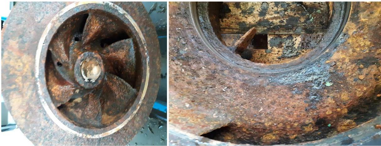
**Figure III.3 :** corrosion de la roue d'une pompe 502-P-001A
