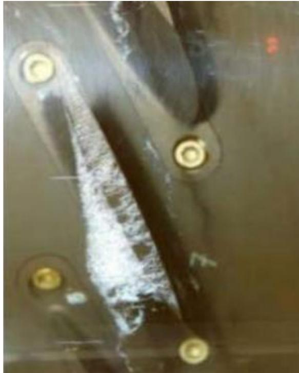
**Figure III.13** : cavitation à poches sur un entrefer de roue
