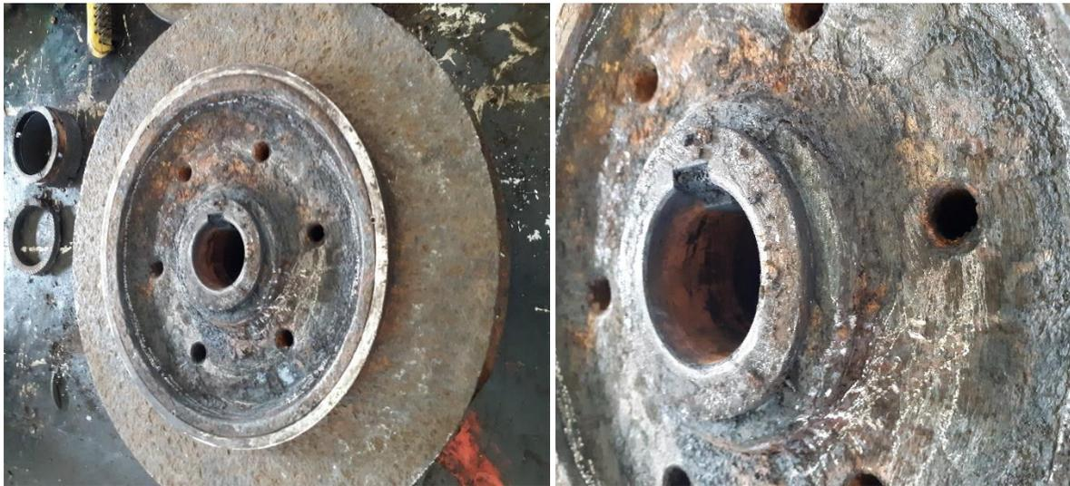
**Figure III.6 :** brossage au niveau de l'impulseur de la pompe 502-P-001A.
