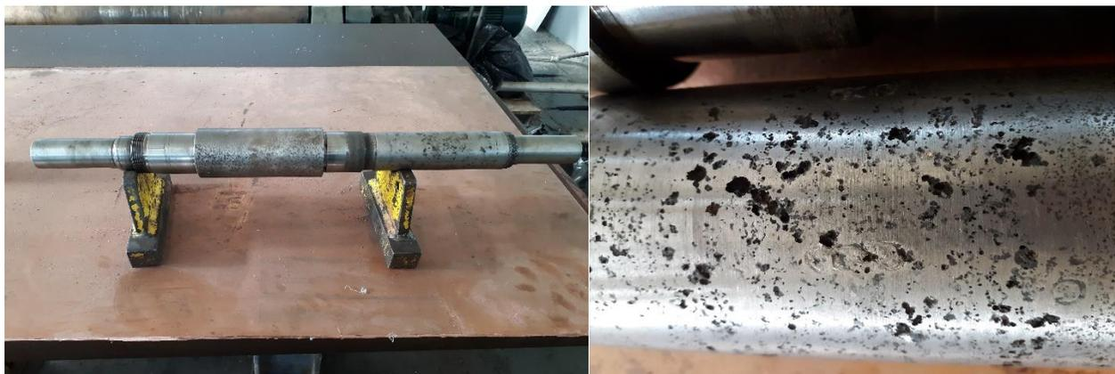
**Figure III.4 :** érosion de l'arbre d'une pompe 502-P-001A
