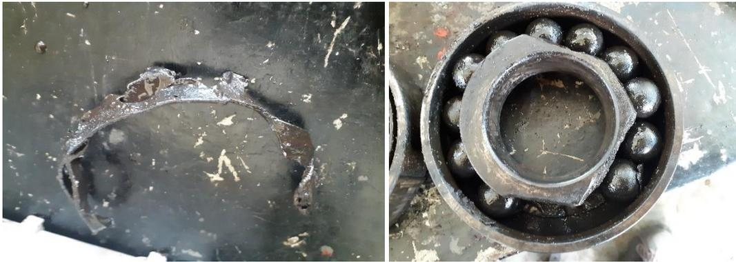
**Figure III .5 :** dommage d'un roulement
