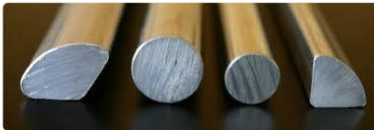
Figure II. 5 : Les conducteurs aluminium massifs ronds ou sectoriels.
