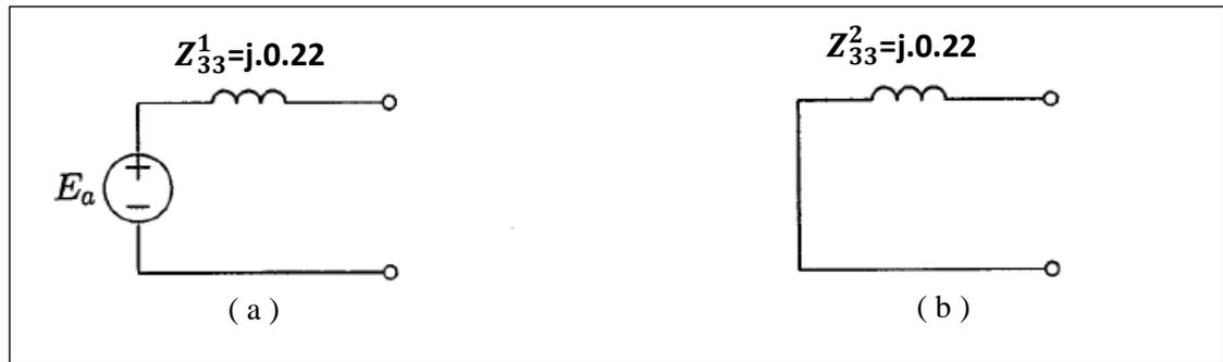
Figure V.3. : Schéma équivalent de la composante directe (a) et inverse (b).
