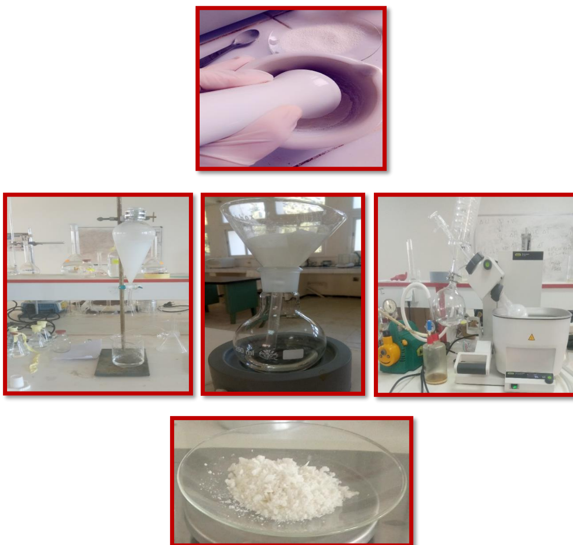
Figure V.2. Étapes suivies pour l'obtention du gliclazide (broyage, extraction liquide-liquide, lavage-séchage-filtration et évaporation)
