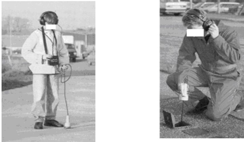
**Figure II-7: Appareils d’auscultation ; les tiges d’écoute (à gauche) et microphones (à droite)**
