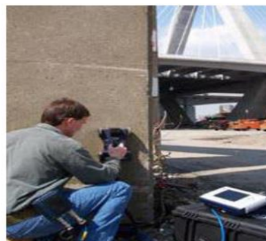
Figure II.16 : Un système géoradar spécial pour les surfaces réduites.
