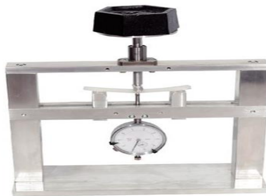
Figure II.21 : portiques pour essais de flexion
