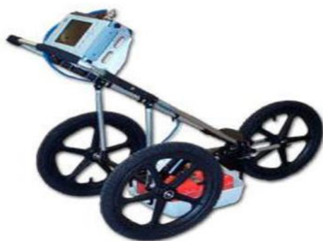
Figure II.15 : Un système géoradar portable comportant une antenne centrée sur 400 MHz.
