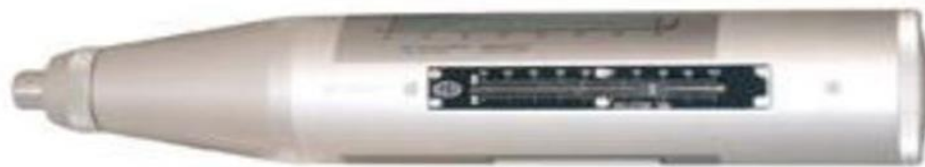
Figure II.1 : scléromètre ou marteau de Schmidt
