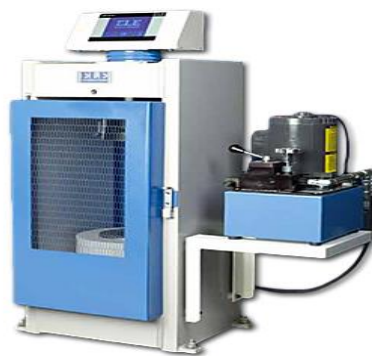
Figure II.22 : Machine d'essais de compression
