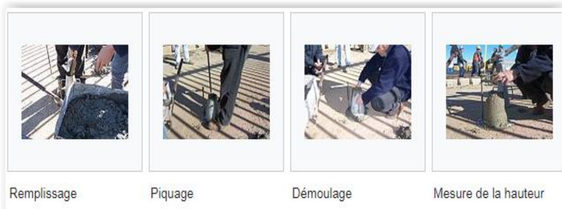
Figure II.12 : Différentes phases de l'essai d'affaissement par cône d'Abrams
