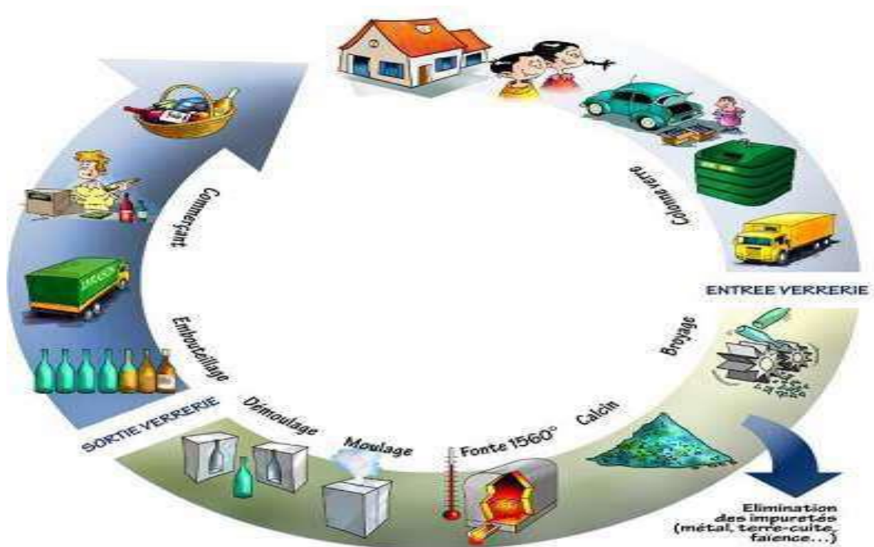
Figure I.7 : Processus de transformation de déchets de verre [16]
