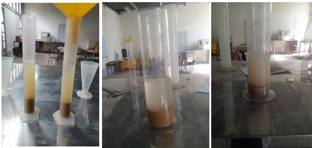
Figure III.5: Essai de la masse volumique absolue du sable utilisé.
