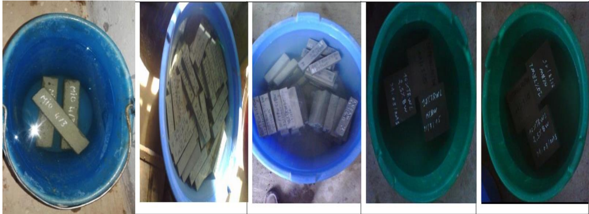
Figure III.19: Cure à l'eau pendant 28 jours des éprouvettes.
