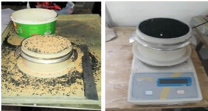
Figure III.12 : Essais de la masse volumique apparente du mélange de sable de dune à différents pourcentages de caoutchouc.
