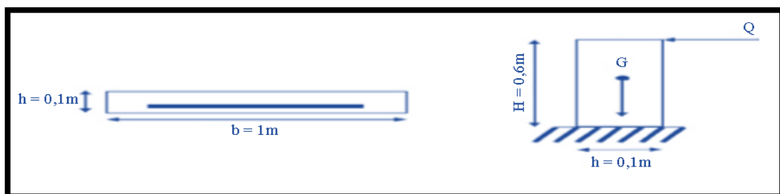
Figure III.1. Coupe transversale et longitudinale de l'acrotère.
