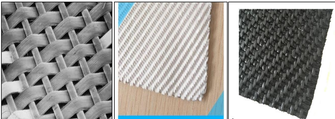
Figure 1.3 Les géotextiles tissés
