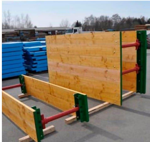
Figure II.4. Les caissons en bois.
