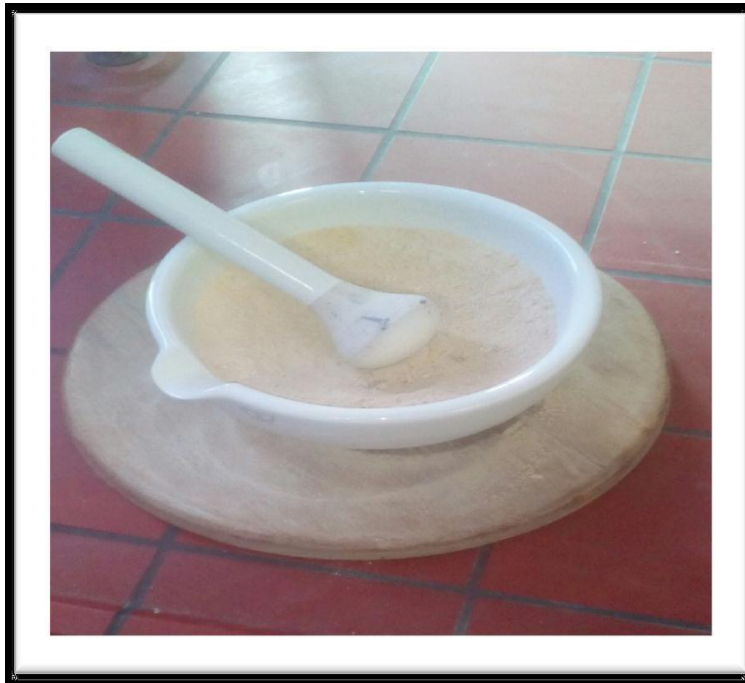
Figure. 4.2 : Le broyage du kaolin brut.
