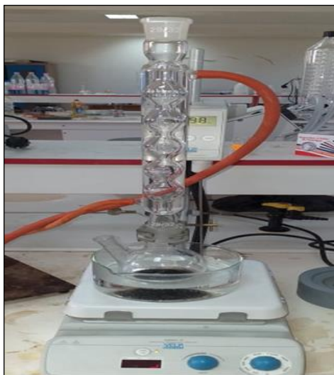
Figure III-3: Image photographique de montage au reflux.
