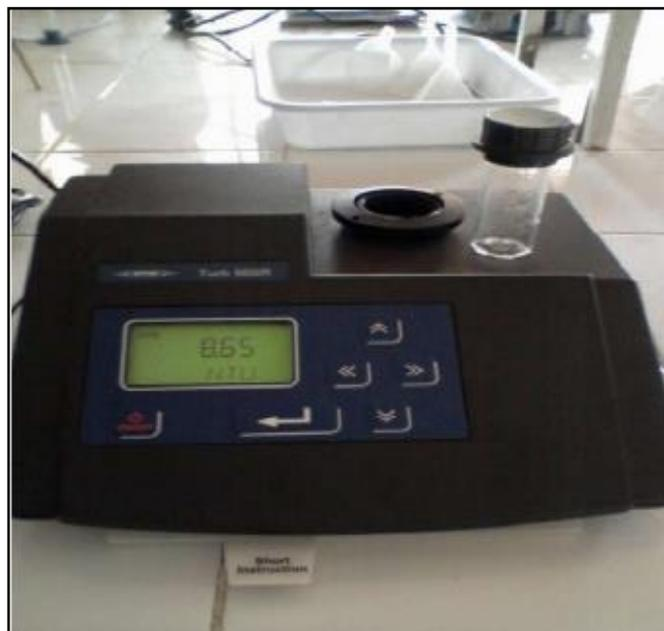
**Figure II. II.4 : Turbidimètre [12]**
