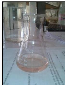
**Figure II.II.10 : Détermination du TAC.**
