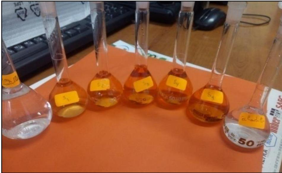
Figure II.II.14 : Préparation des solutions étalons (Si)
