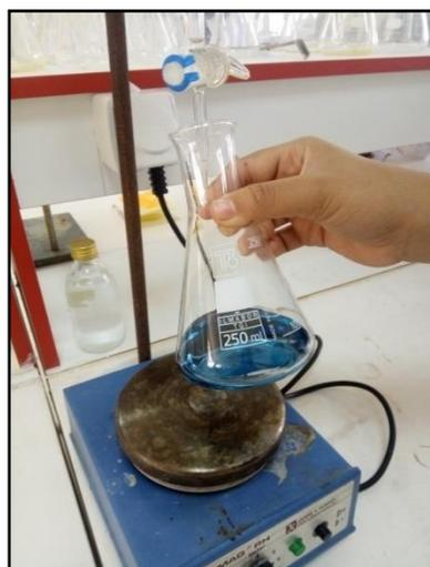
**Figure II.II.7 : Dosage de la dureté de l'eau.**
