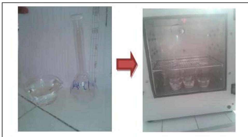
**Figure II. II.3 : Détermination du résidu sec [12].**
