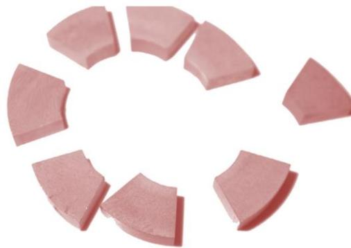
FIGURE 4.8 Pièce en forme de coin de l'unité PZT de torsion [1], [4].
