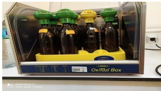
Figure III- 7 : Appareillage de détermination de la DBO<sub>5</sub>.
