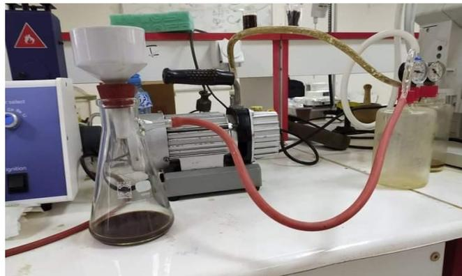
Figure III -2 : Dispositif de filtration de margine.
