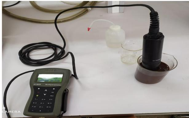
Figure III- 4 : Appareil de PH-mètre.
