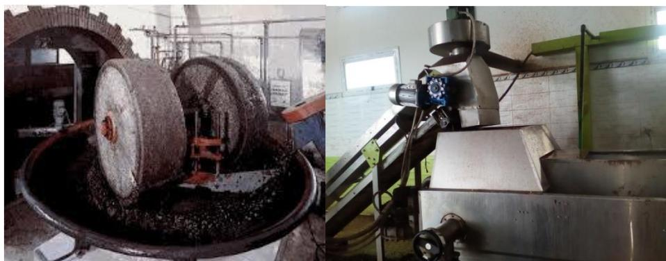
Figure I-3 : a) Broyeur à meule en pierre b) Broyeur à marteaux
