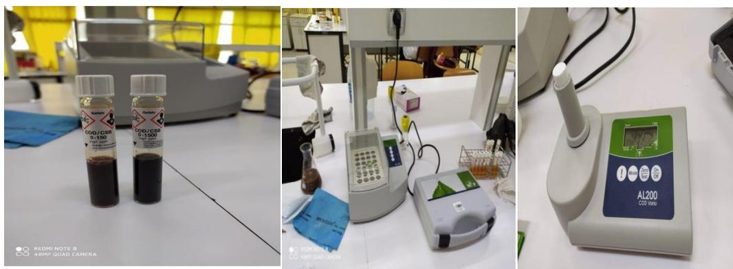
Figure III- 8 : Appareillage de détermination de la DCO.
