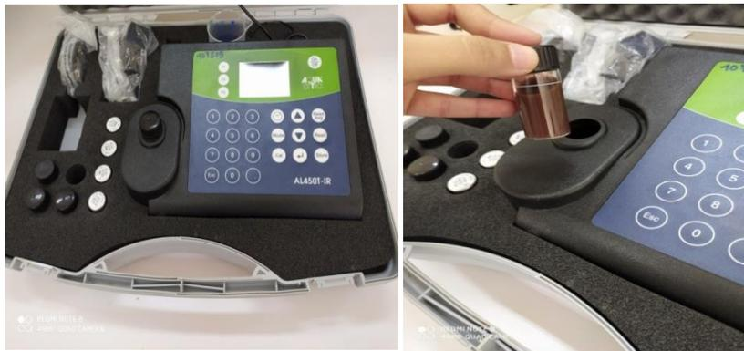
**Figure III- 5 :** Dispositif de la détermination de la turbidité.
