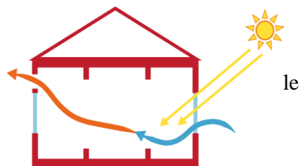
Figure (12) : la ventilation naturelle, (source : maison.fr/la-ventilation-naturelle/)
