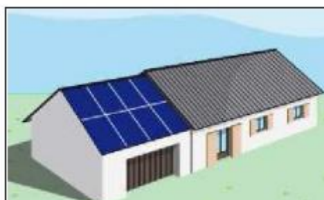
Figure 56: Intégration du capteur sur une partie de la toiture en pente d'un bâtiment Source : M. BENAMRA (Mostefa Lamine) : Intégration des systèmes solaires photovoltaïques dans le bâtiment : Approche architecturale, Université de BISKRA, 2013
