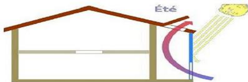
Figure 24: Figure la ventilation de la serre en été (jour) (Source : la conception bioclimatiques des maisons confortable et économes Samuel courgeyet jean pierre Oliva)
