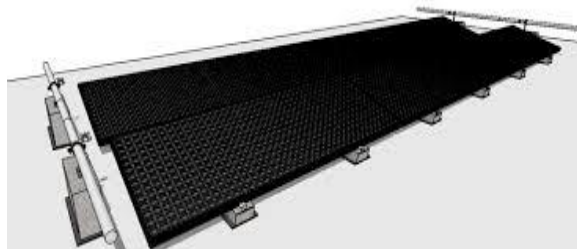
Figure 31: capteur non vitré, source : Mémoire de fin d'étude : ARCHITECTURE ET EFFICACITE ENERGETIQUE DES PANNEAUX SOLAIRES présenté par mabouche azouz université de Mentouri juin 2012
