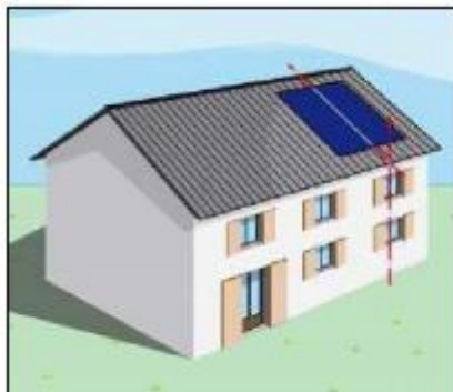
Figure 55: Installation du capteur sur une toiture inclinée respectant l'axe de la fenêtre Source : M. BENAMRA (Mostefa Lamine) : Intégration des systèmes solaires photovoltaïques dans le bâtiment : Approche architecturale, Université de BISKRA, 2013
