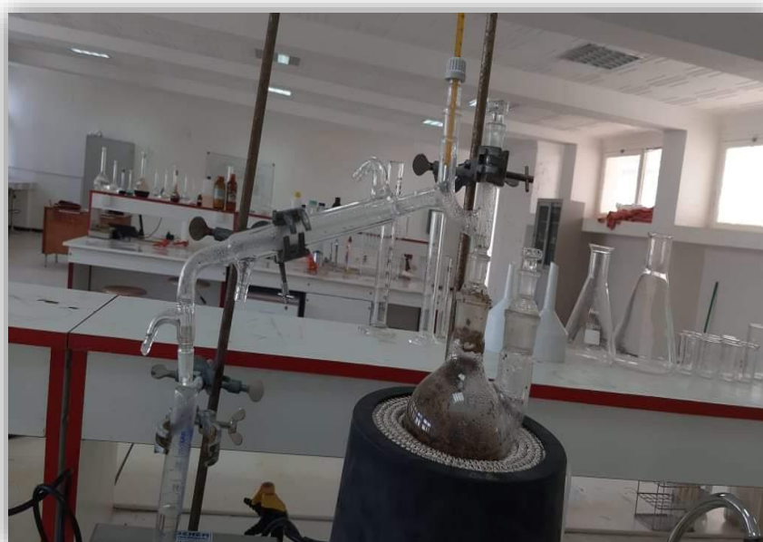
Figure 35 : Extraction de l'huile essentielle du clou de girofle par hydrodistillation
