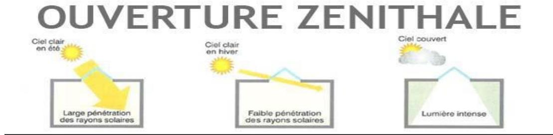
Figure 24 : Exemple de l'éclairage zénithal. (Source : UCL Architecture et
