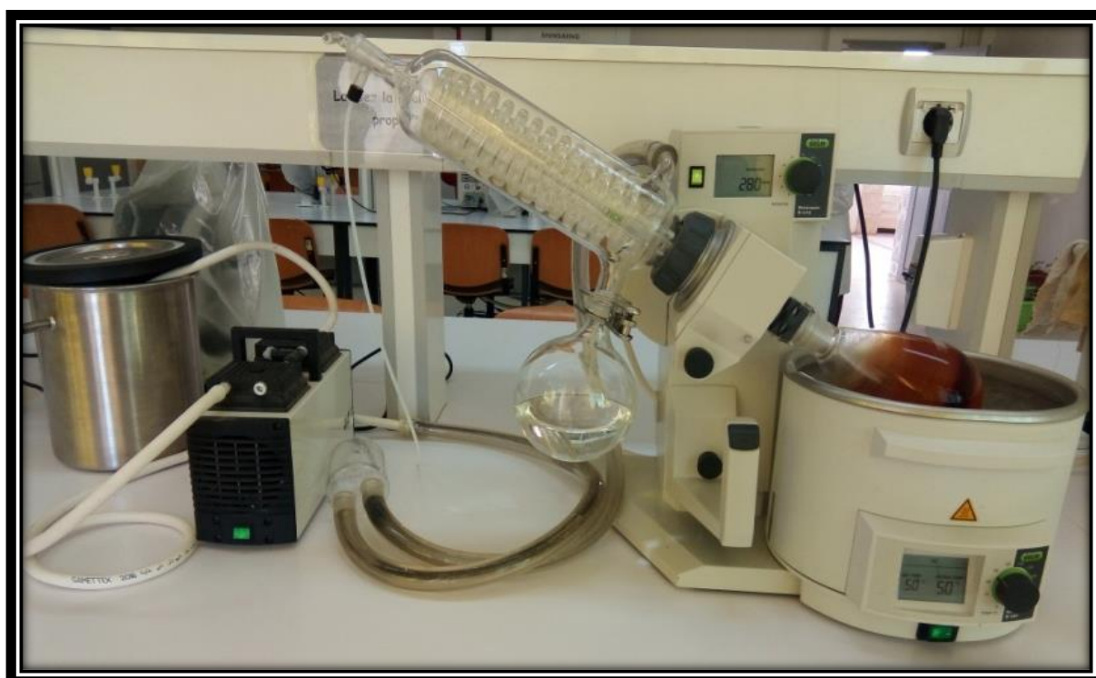
Figure 8: L'évaporation de l'extrait dans Rotavapor®-215.
