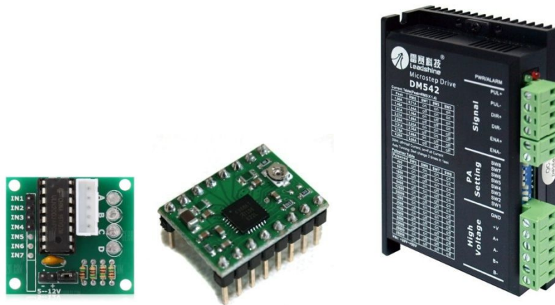
Figure 13. Différentes catégories de driver de moteur pas-à-pas. A droite c'est driver ULN2003, au centre un driver A4988 et à gauche à driver DM542
