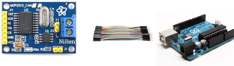
Figure 4.3. Matériel utilisé pour faire communiquer deux Arduino via le bus CAN
