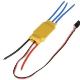
Figure 10. Driver ESC pour commander un moteur Brushless
