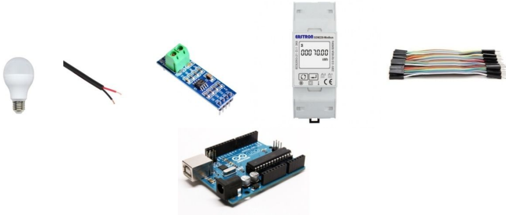
Figure 5.3. Matériel utilisé pour faire communiquer deux Arduino via le bus CAN
