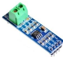
Figure 5.5. Module MAX485 ModBus qui convertit du RS485 vers TTL et vice-versa
