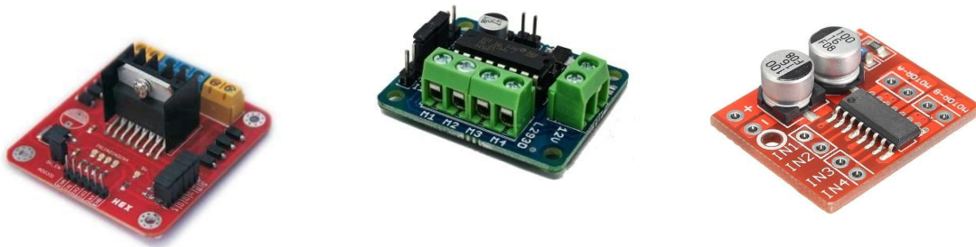
Figure 2. Exemple de différents drivers à base de pont-H. A gauche un driver L298N, au centre un driver L293D et à droite un driver MX1508.
