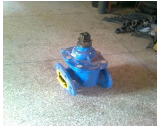
Figure 14 : Vanne de sectionnement
