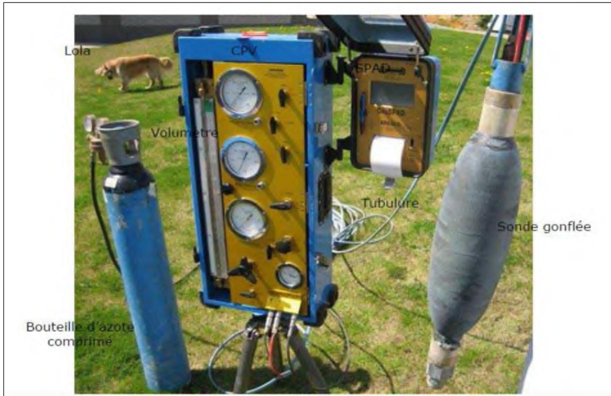
**Figure III.2 :** Appareillages de l'essai pressiométrique.
