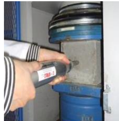
Fig.7.4. Essai sclérométrique sur une éprouvette cubique (10.10.10)cm^3 .
