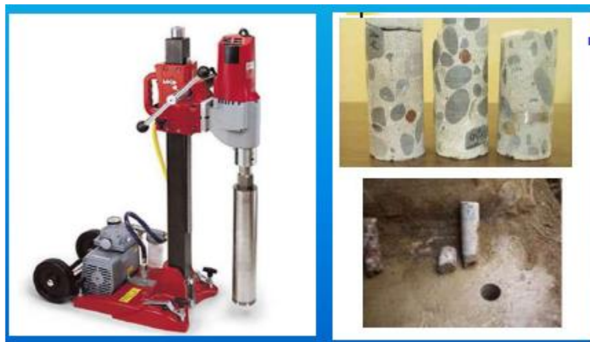
Fig.7.1. Prélèvement des éprouvettes par carottage.
