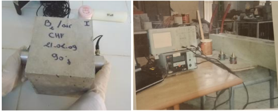
Fig.7.8. Conduite d'un essai ultrasonique.
