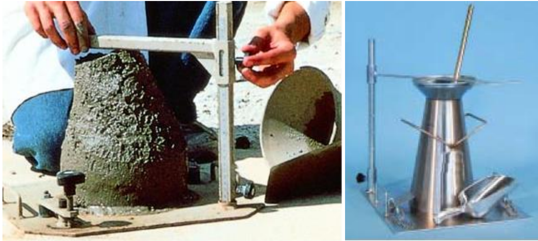
Fig.5. 1. Mesure de la maniabilité à l'aide du cône d'Abrams.
