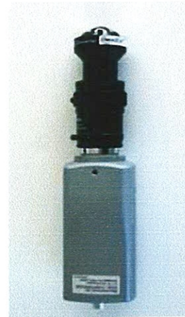
Figure .4 (b) : une caméra « fish-eye » Composée d'une lentille fish-eye et d'une caméra sténopé
