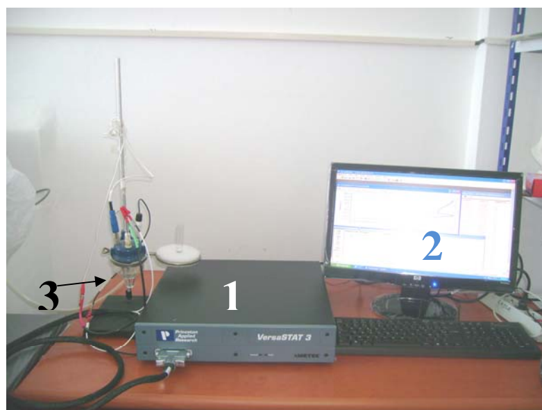
Figure III.11 : Montage de test de corrosion
