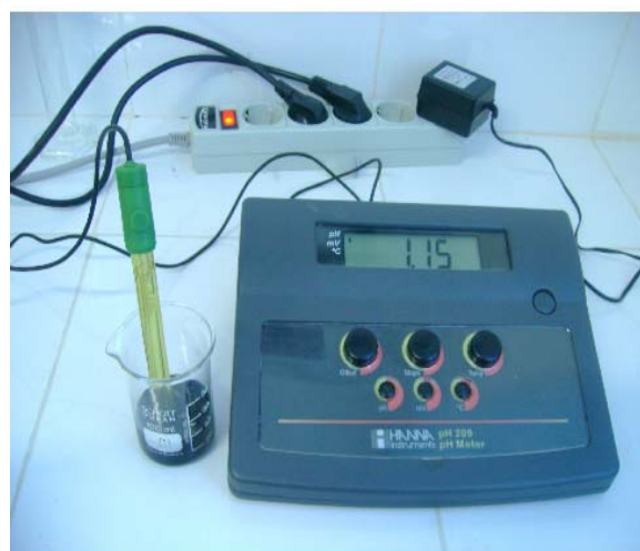
Figure III.5: PH mètre utilisé dans la mesure de pH du bain de chrome trivalent.
