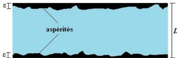
Figure 3.6: la rugosité d'une conduite
