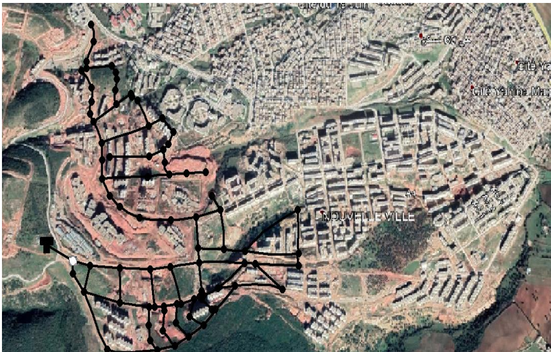
Figure 5.4 : Numérisation du Réseau AEP - Google Earth
