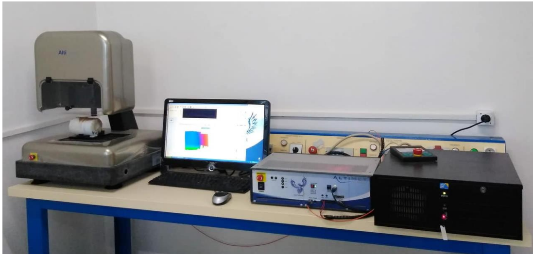
Figure II.13. Plate-forme 3D de métrologie optique modulaire Altisurf 500.
