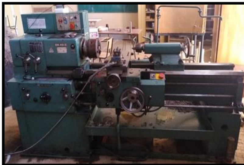
Figure II.1. Machine de Tour à charioter et à fileter modèle SN40.
