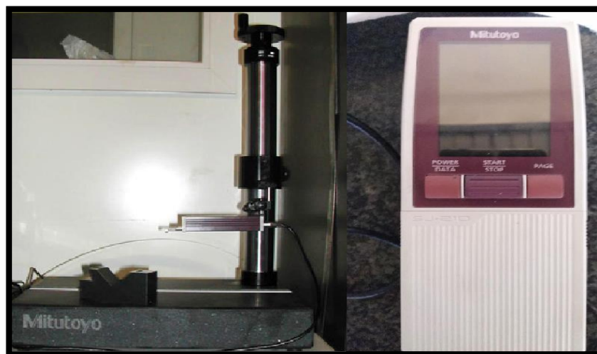
Figure II.12 Rugosimètre MITUTOYO 2D modèle SJ-210.
