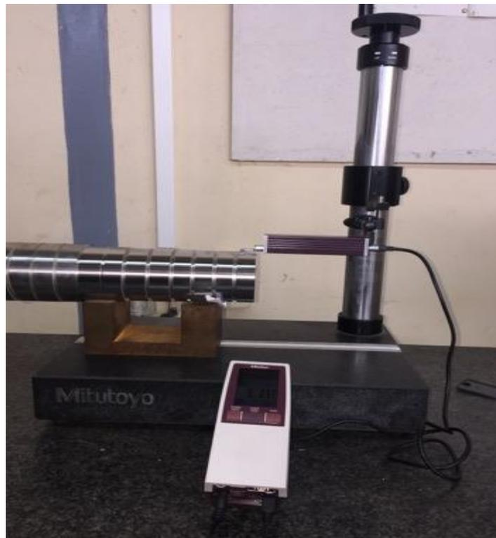
**Figure II.7** Rugosimètre Mitutoyo Modèle Surftest SJ-210.
