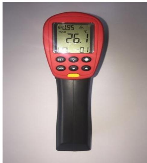
*Figure II.8* Thermomètre infrarouge AMPROBE IR-730
