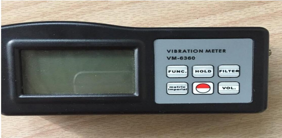
*Figure II.9* Vibromètre Modèle VM-6360.
