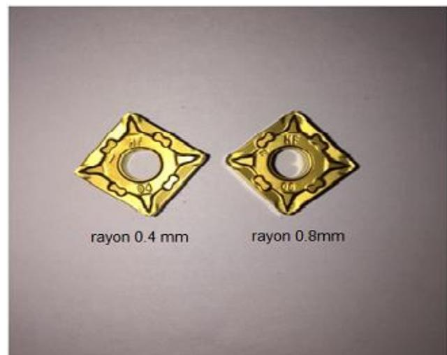
*Figure II.2 Plaquettes de coupe en carbure avec revêtement CVD (GC2015)*
