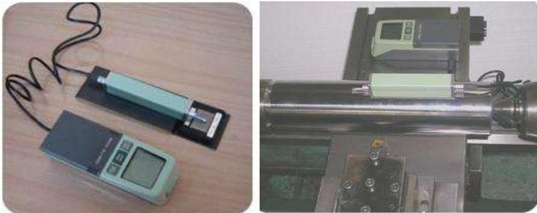
**Figure II-7:** Mesure de rugosité sans démontage de la pièce
