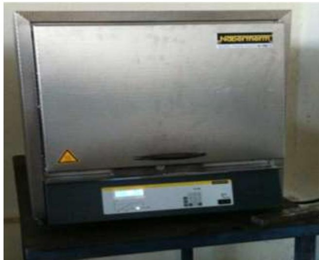
**Figure II-4:** Four à chambre électrique pour le traitement thermique d'éprouvette.
