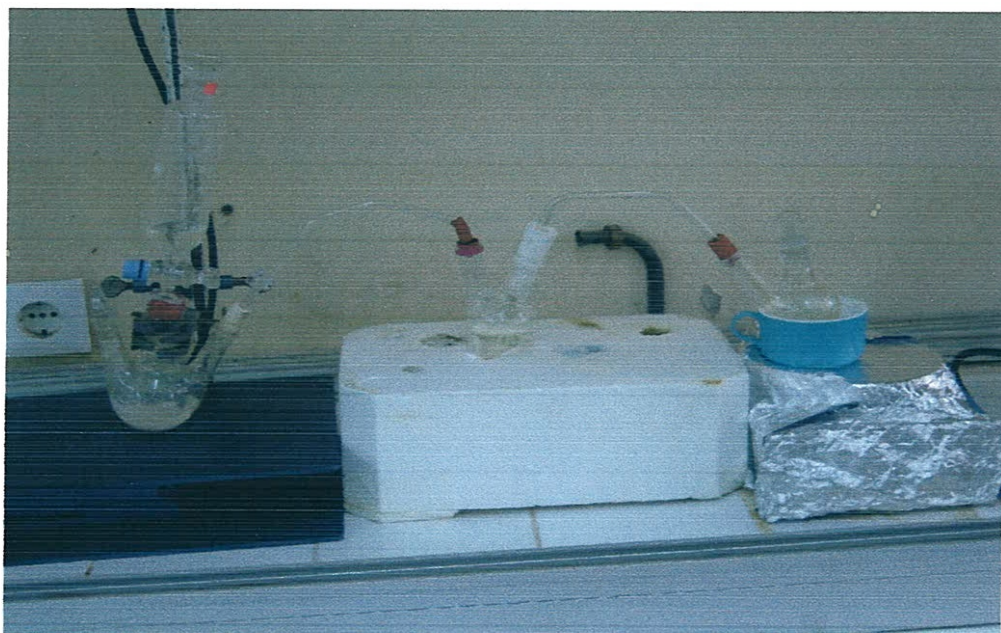
Figure V.1 Montage utilisé pour la préparation de la pipéridine Chlorhydrate.
