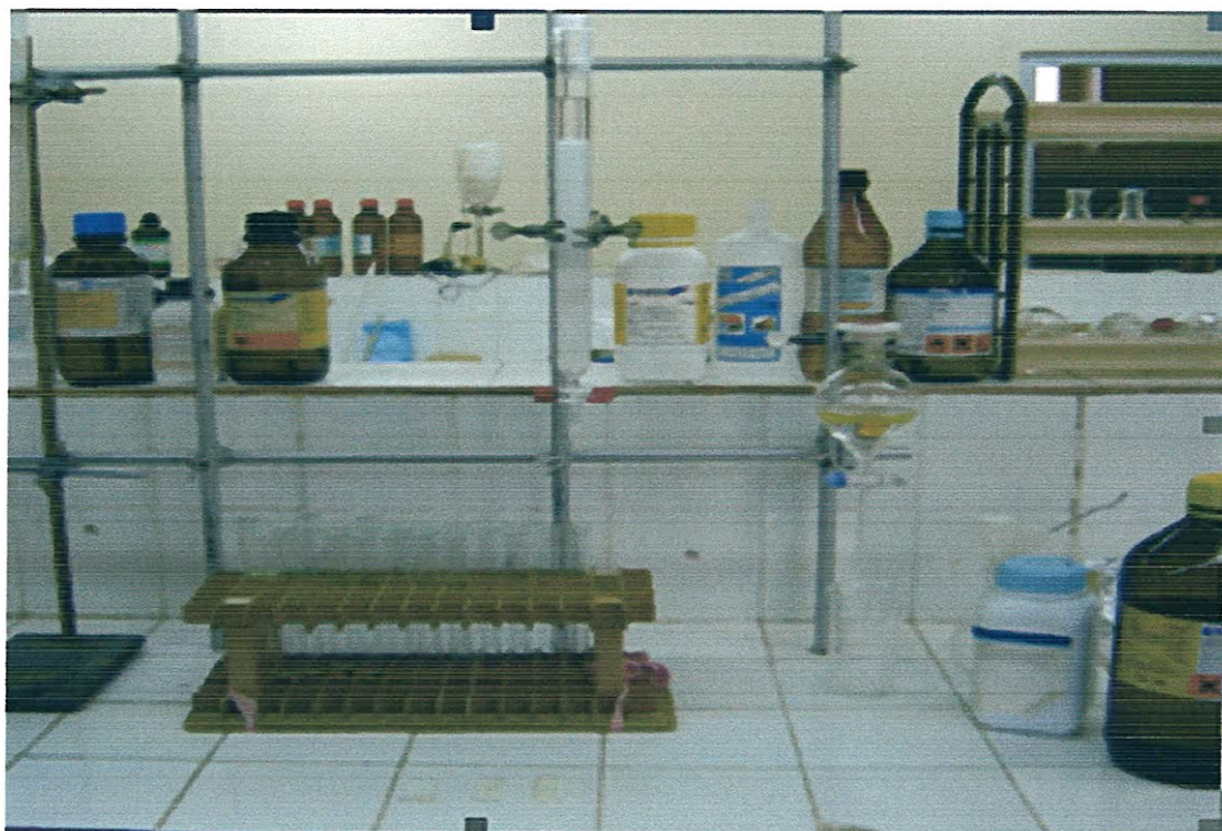
Figure V.11 Séparation sur colonne chromatographique.
