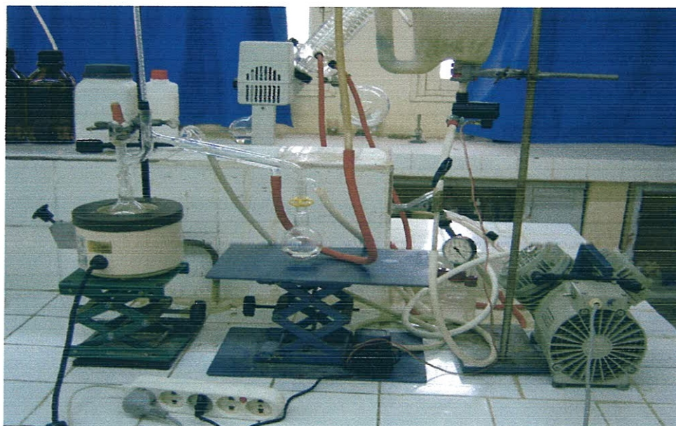
Figure V.6 Montage pour la distillation des esters aromates.
