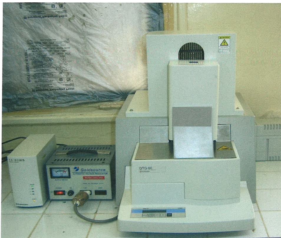
Figure 22: Appareil d'analyse thermique différentielle et thermogravimétrie, couplées de type shumadzu DTG 60
