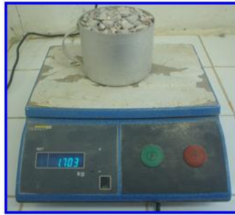
Figure II.1 : Procédé utilisé pour la mesure de la masse volumique apparente des graviers.
