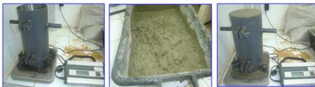
Figure II.21 : Mesure de la densité des bétons à l'état frais.
