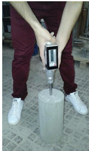
Figure III.16 : Conduite d'un essai sclérométrique sur éprouvette (16.32) cm 2 .
