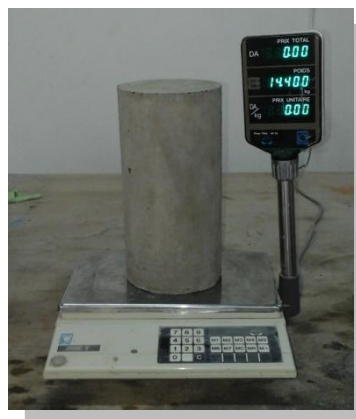
Figure III.2 : Mesure de la masse volumique des bétons à l'état durci.
