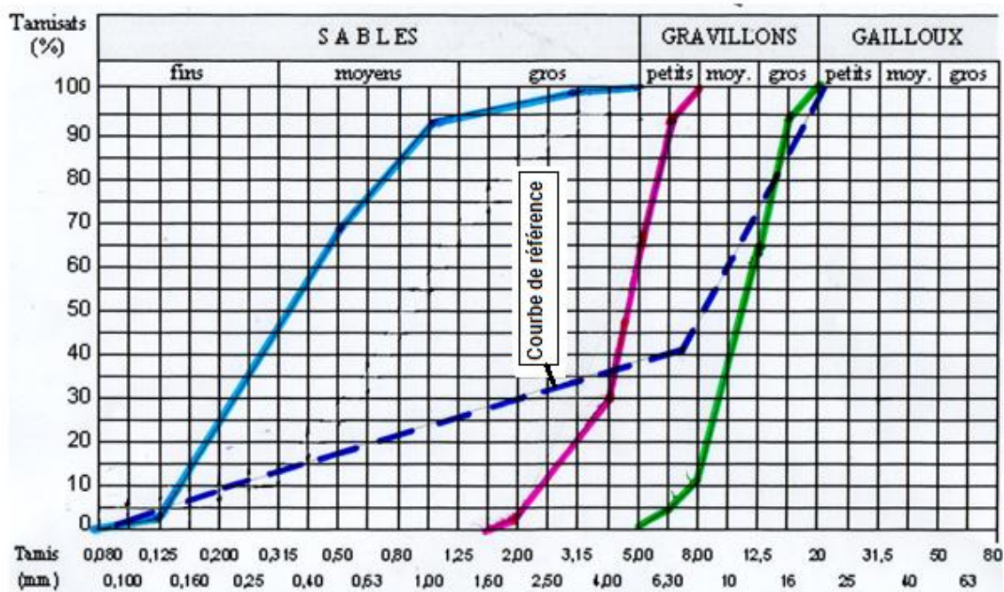
Figure II.15 : Courbes de référence du béton selon la méthode de Dreux-Gorisse.
