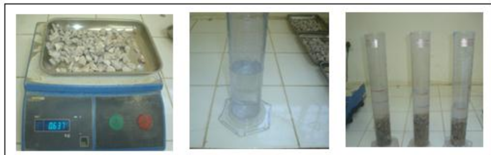
Figure II.2 : Mesure de la masse volumique absolue des graviers.
