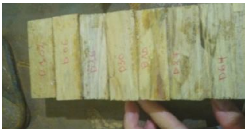
Figure II. 3: Délamination dans l'éprouvette collée par la Résine.
