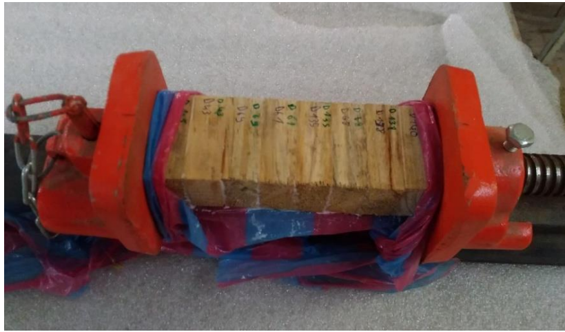
Figure I. 6: mise sous pression des éprouvettes.
