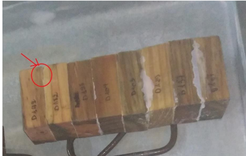
Figure II. 2: Délamination dans l'éprouvette collée par l'Epoxy.
