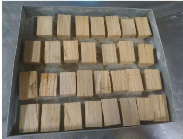
Figure I. 8: éprouvettes pour la mesure de la densité et teneur en eau.
