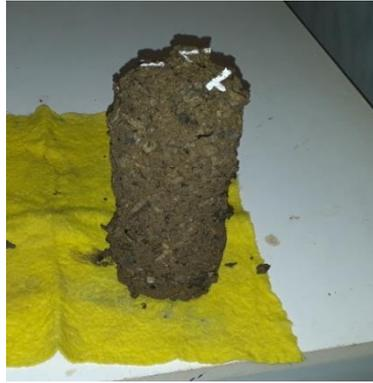
Figure 96 : Photo de l'éprouvette de marne traitée au LHR à 5% après 6 cycles humidification-séchage.
