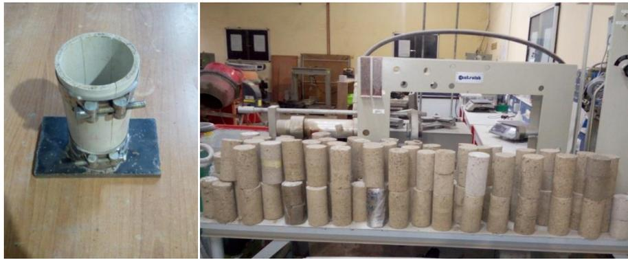
Figure 78 : Photos du moules et des éprouvettes confectionnées.
