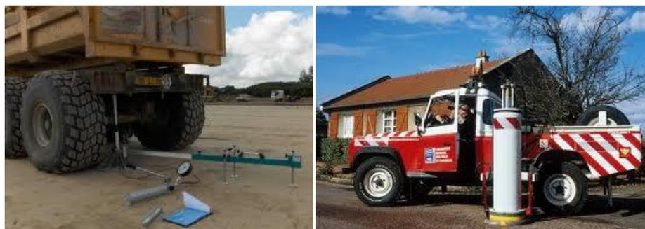
Figure 30 : Photos de l'essai à la plaque et à la dynaplaque.
