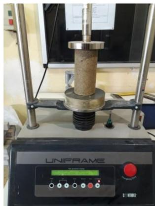
Figure 82 : Photo de l'essai de résistance à la compression simple.
