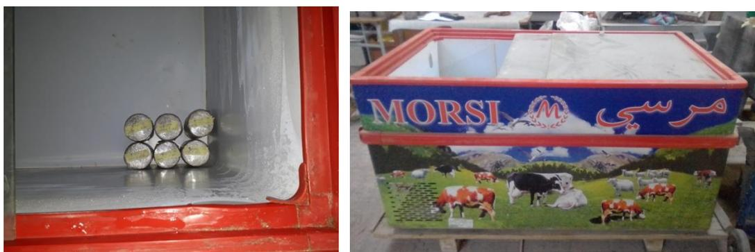
Figure 80 : Photo des éprouvettes de marne traitée dans le congélateur.
