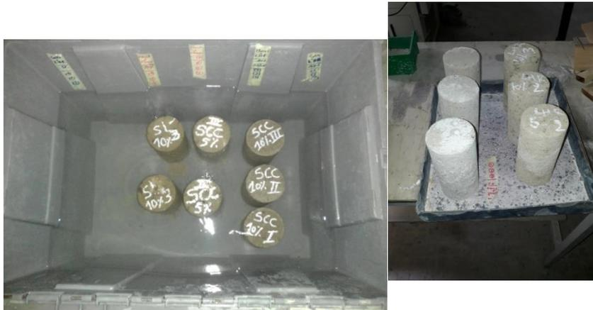
Figure 81 : Photos des éprouvettes soumises aux cycles humidification-séchage.
