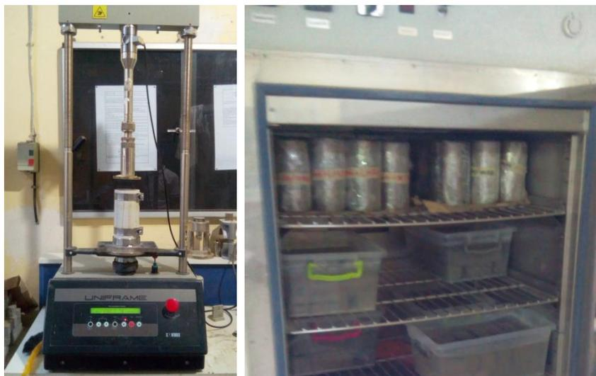
Figure 79 : Photos la machine de compactage UNIFRAME et de la chambre climatique.
