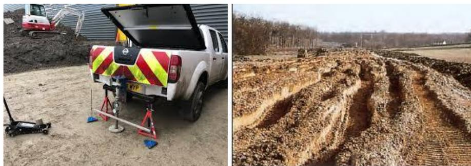
Figure 31 : Photos de l'essai IPI in situ et mesure de la profondeur d'ornièrage.
