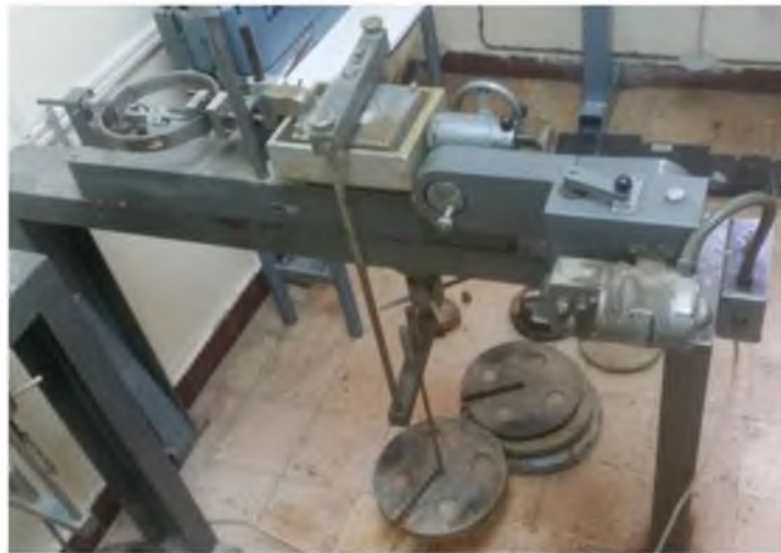
Figure 3.1 : La boîte de cisaillement (Wykham Farrance).
