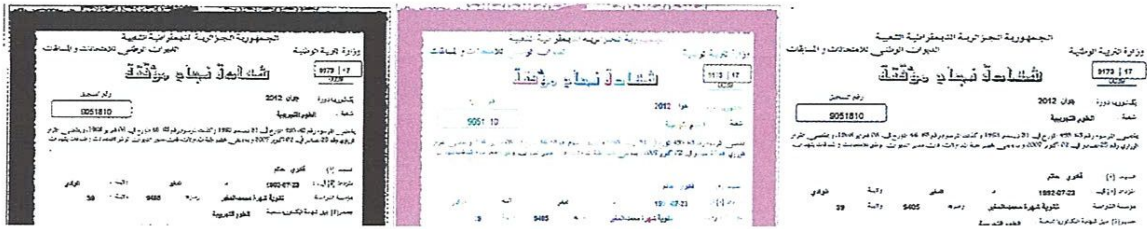
(a) détection de bordure (b) Etiquetage des composantes connexes (c) suppression de bordure Figure 3.6 : Détection de la bordure, étiquetage des composantes connexes, et suppression de la bordure.
