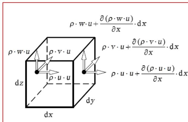
Figure II.1 : Quantité de mouvement entrant et sortant dans l'axe x [6] chapitre 5 page 217
