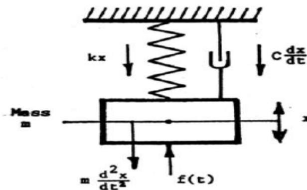
Figure III.1 Simulation d'un système vibratoire
