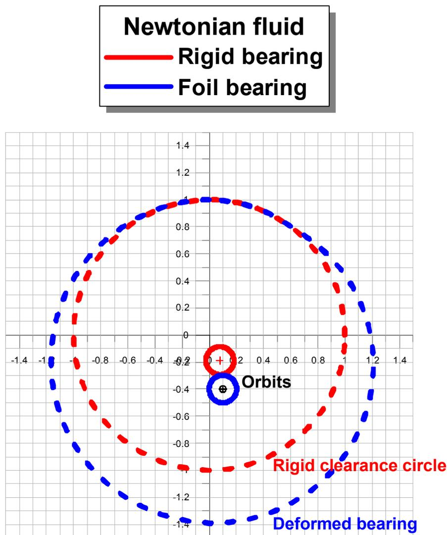
Fig. IV.16 Orbite palier rigide et déformable en fluide Newtonien
