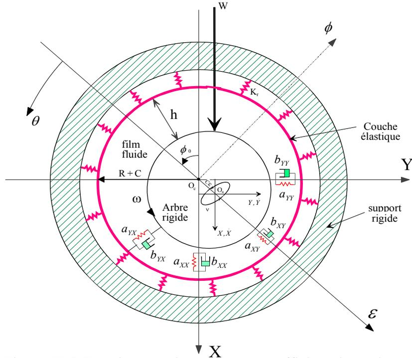
Figure III.2 Coordonnées du système et coefficient dynamiques
