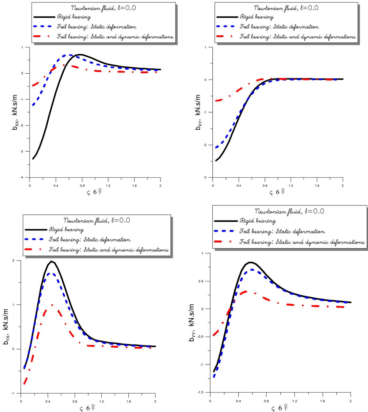
Fig. IV.13 Influence de la déformation des feuilles sur les coefficients de raideurs
