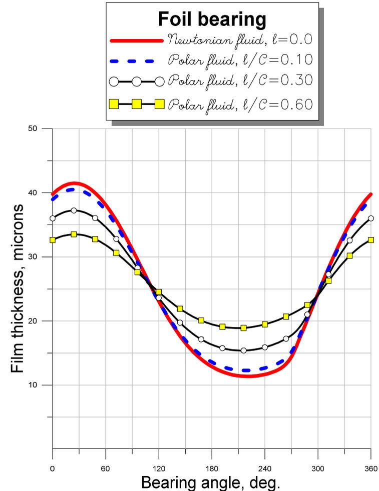
!!! Dans le cas du fluide polaire, la variation de la hauteur film s'effectue de faible amplitude et vient sécuriser la rotation de l'arbre dans la zone critique
