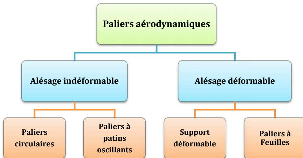
Figure I.3 : Principales architectures de paliers à air
