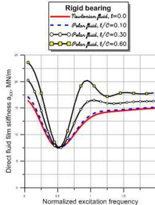
Pratiquement le même impact sur les coefficients directs du palier rigide et du palier MITI. À  $l/C=0.1$ , l'effet est déjà remarquable sur le palier à feuilles, des valeurs légèrement inférieurs en MN/m en MITI
