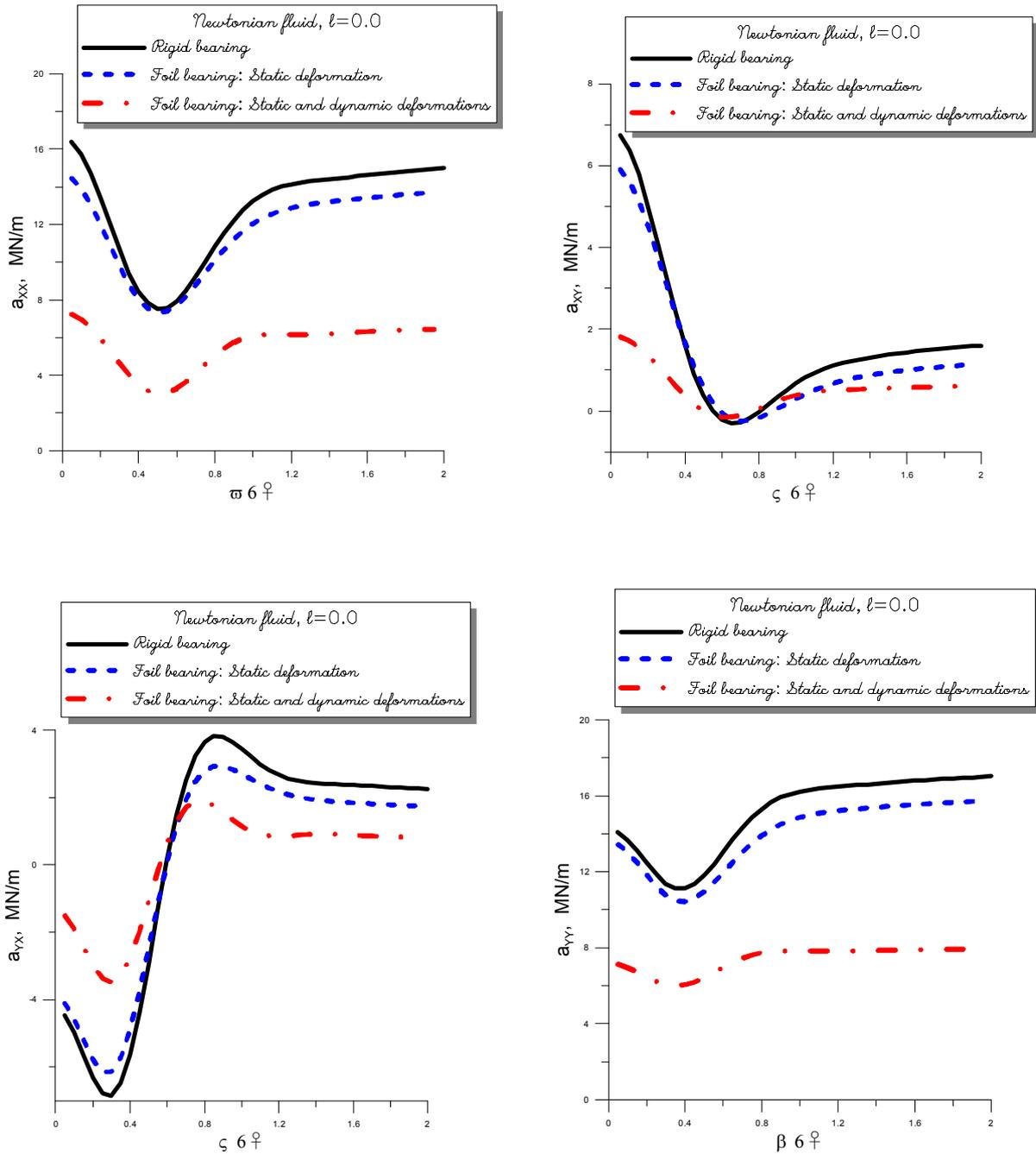
Fig. IV.12 Influence de la déformation des feuilles sur les coefficients de raideurs
