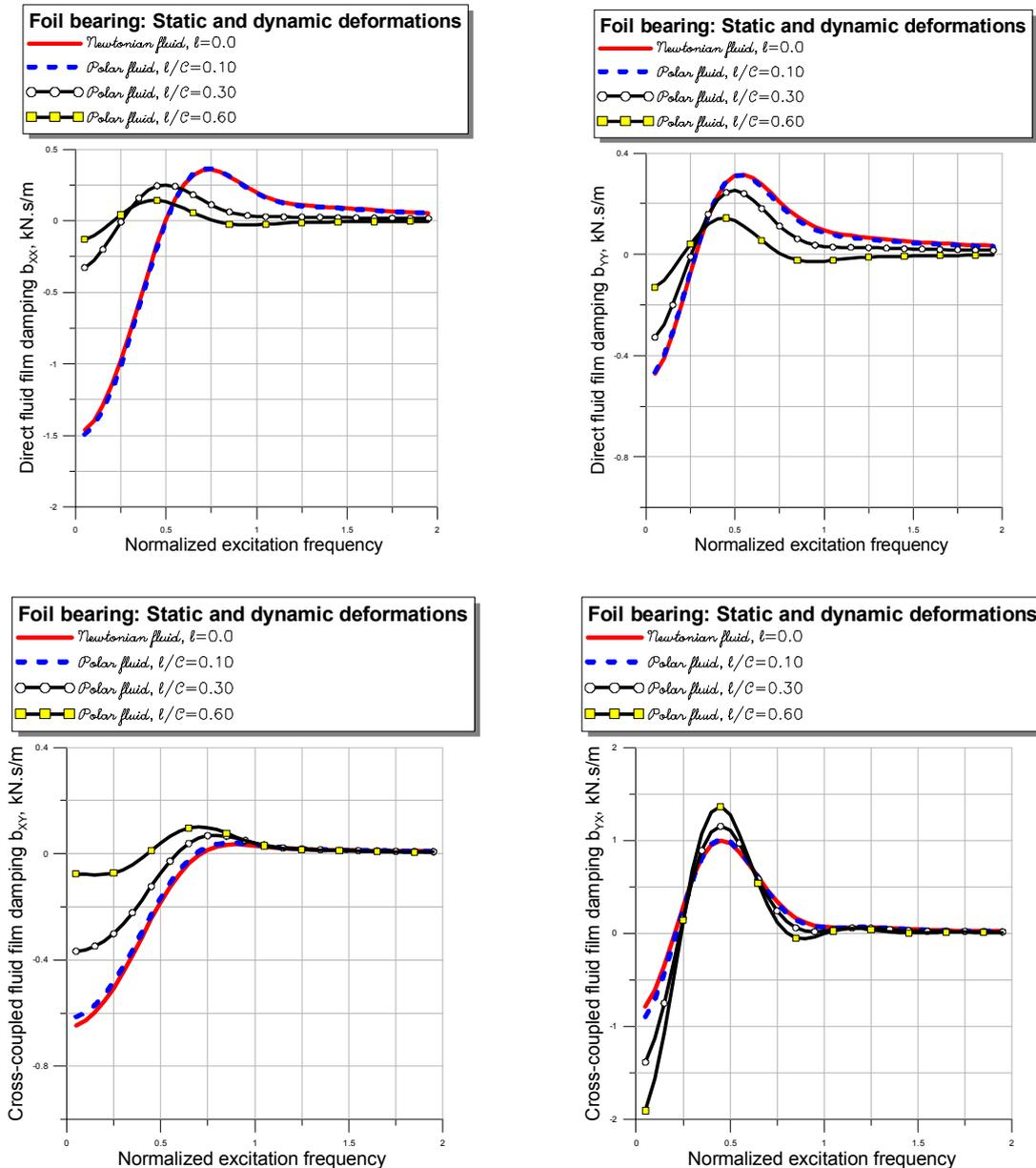
Fig. IV.11 Influence des couples de contraintes sur les coefficients d'amortissement directs et indirects en cas de déformation statique et dynamique
