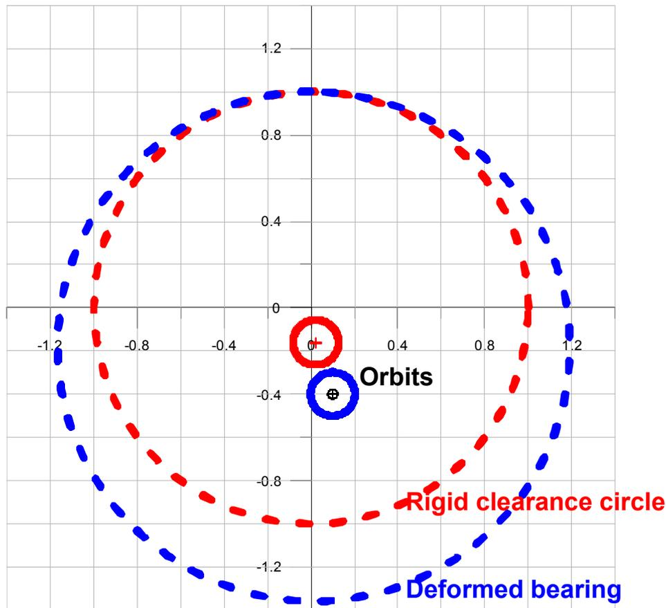
Fig. IV.17 Orbite palier rigide et déformable en fluide Polaire
