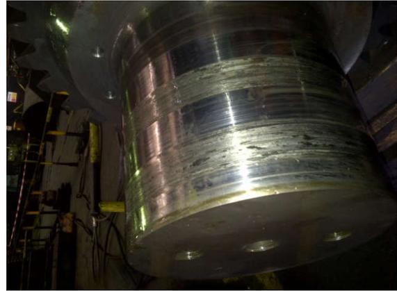
Figure I.2 : Palier lisse à régule et arbre endommagés
