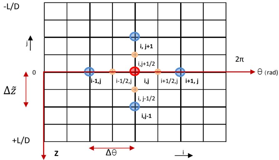
Figure III.5 Maillage du film lubrifiant
