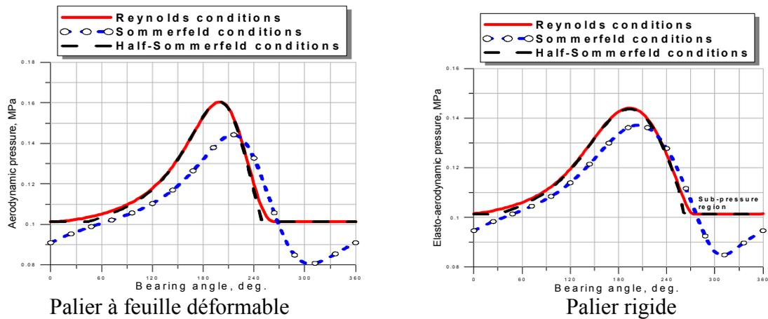
Fig. IV.1 Influence des CL sur le profil de pression
