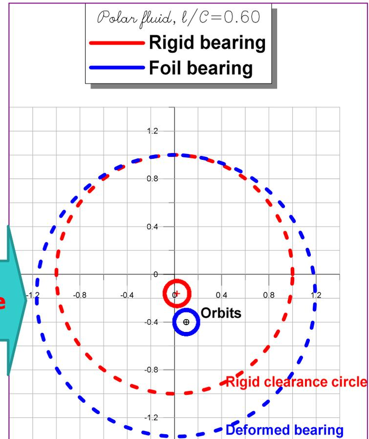
La déformation élastique de l'alésage du palier sous l'effet de la pression du fluide
