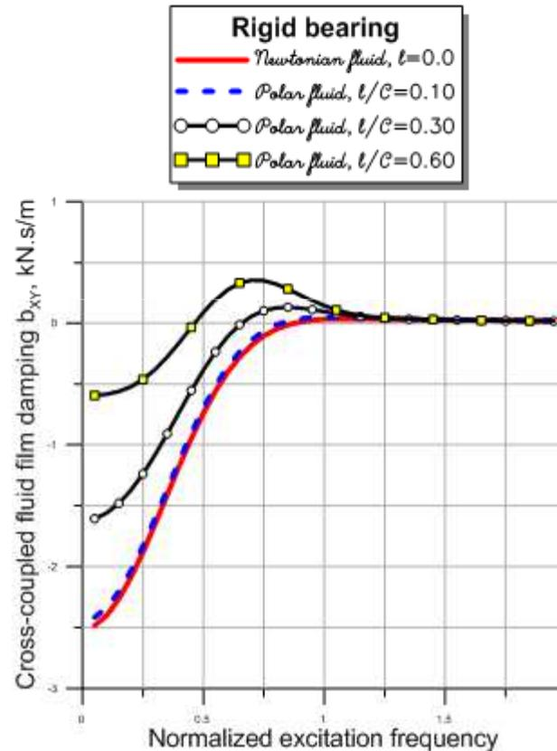
Même choses sur les coefficients d'amortissement, l'impact est plus importants sur les coefficients indirects.
