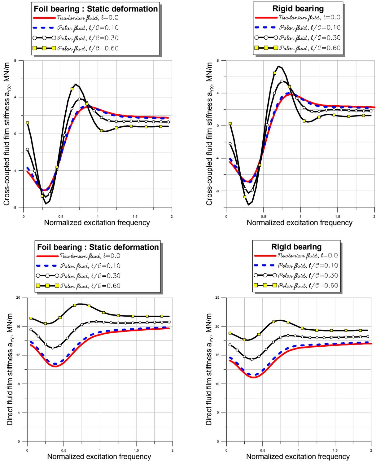
Fig. IV.7 Influence des couples de contraintes sur la raideur directe et indirecte dans l'axe Y
