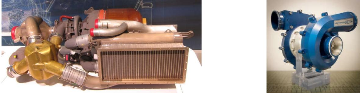
Fig. 2 Photographies d'un ACM avec pack de refroidissement et d'un ACM MITI allégé
