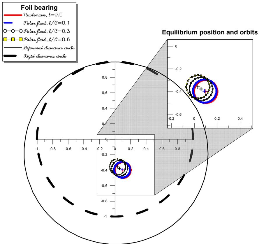
Fig. IV.14 Orbites du centre de l'arbre du palier à feuille selon le type de fluide
