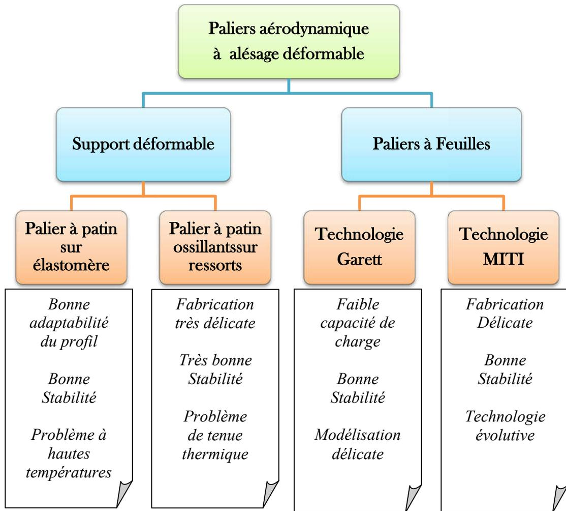
Figure I.7 Types de paliers à alésage déformable
