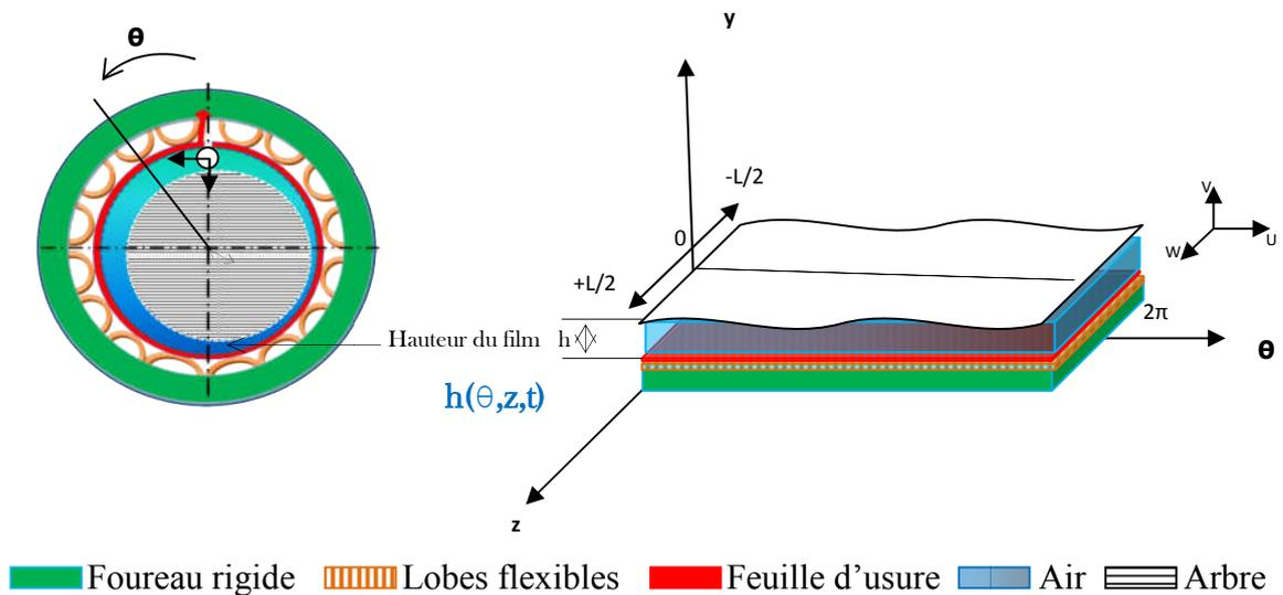
Figure III.4 Développement du palier dans l'axe thêta
