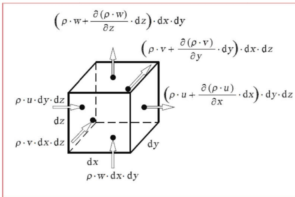
Figure A.1 : Flux de masse entrants et sortants. Source [6] chapitre 5 page 217
