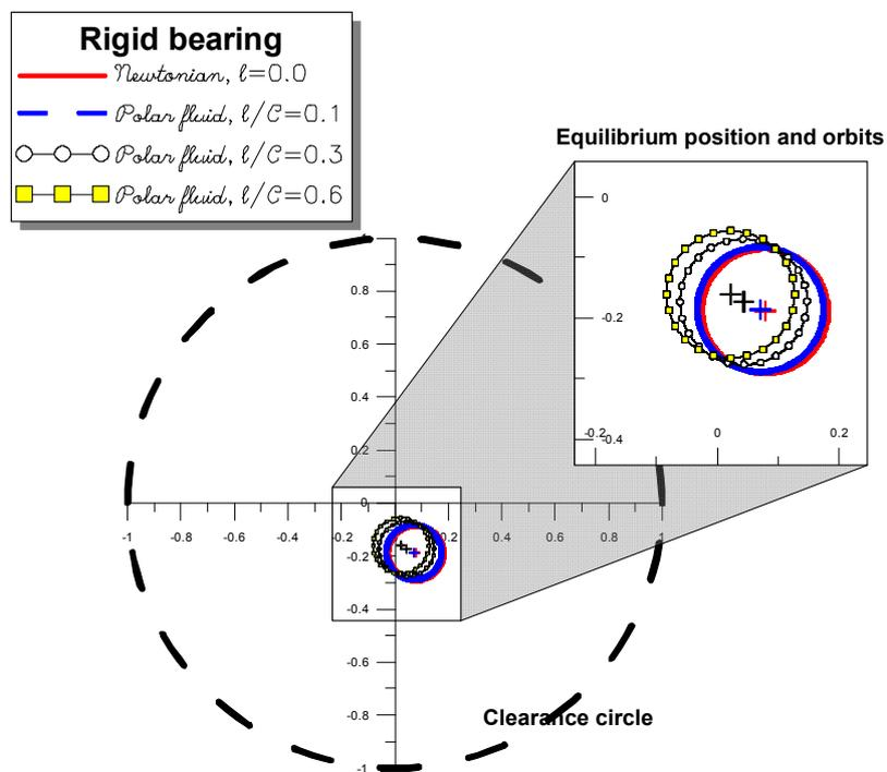
Fig. IV.15 Orbites du centre de l'arbre du palier rigide selon le type de fluide
