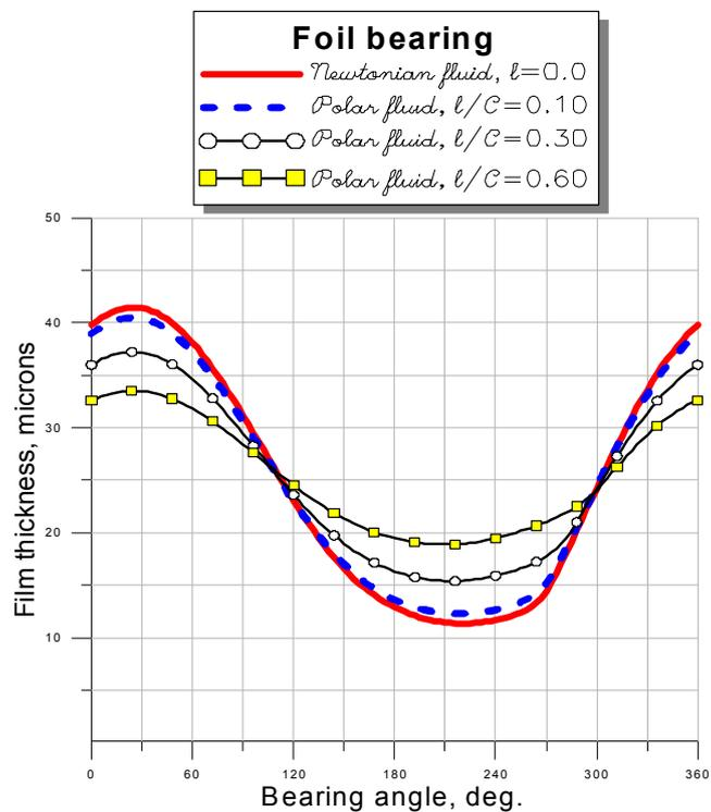
Fig. IV.5 Influence des couples de contraintes sur la géométrie du film pour palier à feuille
