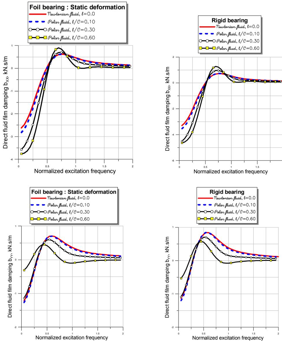
Fig. IV.8 Influence des couples de contraintes sur les coefficients d'amortissement directs
