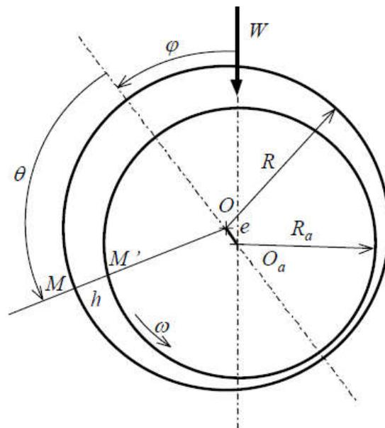
Figure I.4 : Palier cylindrique lisse [8]
