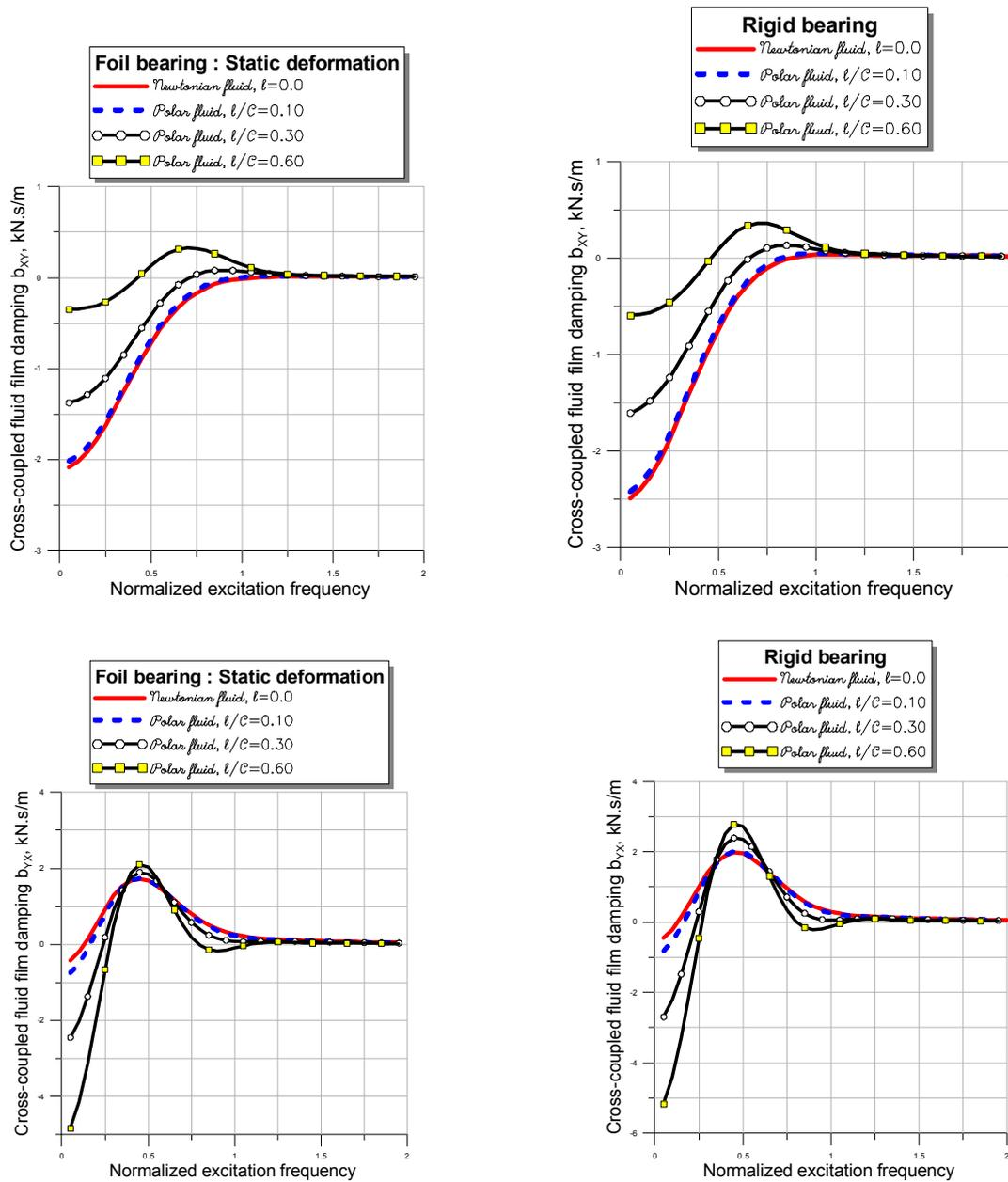
Fig. IV.9 Influence des couples de contraintes sur les coefficients d'amortissement indirects
