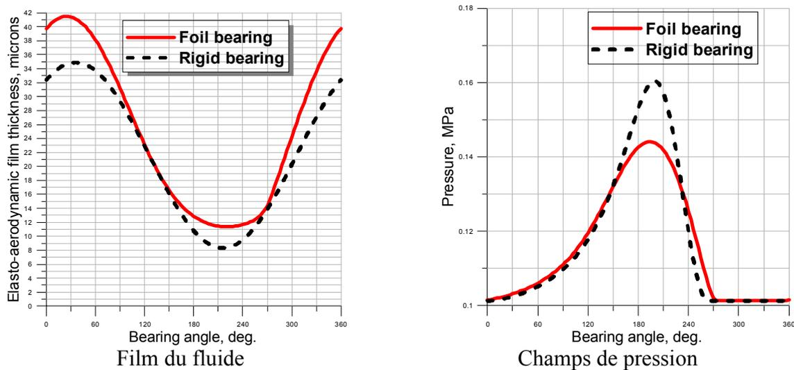
Fig. IV.3 Influence de déformation élastique sur la géométrie du film et le champ de pression
