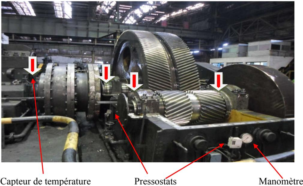
Figure I.1 : Paliers d'un Laminoir refroidis à l'huile Puissance 2x1200KW
