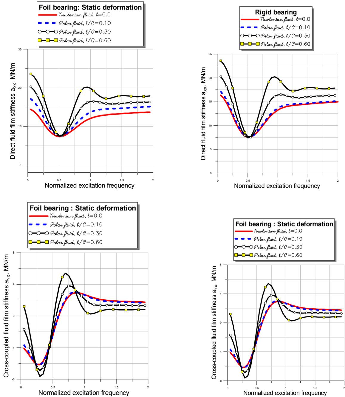
Fig. IV.6 Influence des couples de contraintes sur la raideur directe et indirecte dans l'axe X
