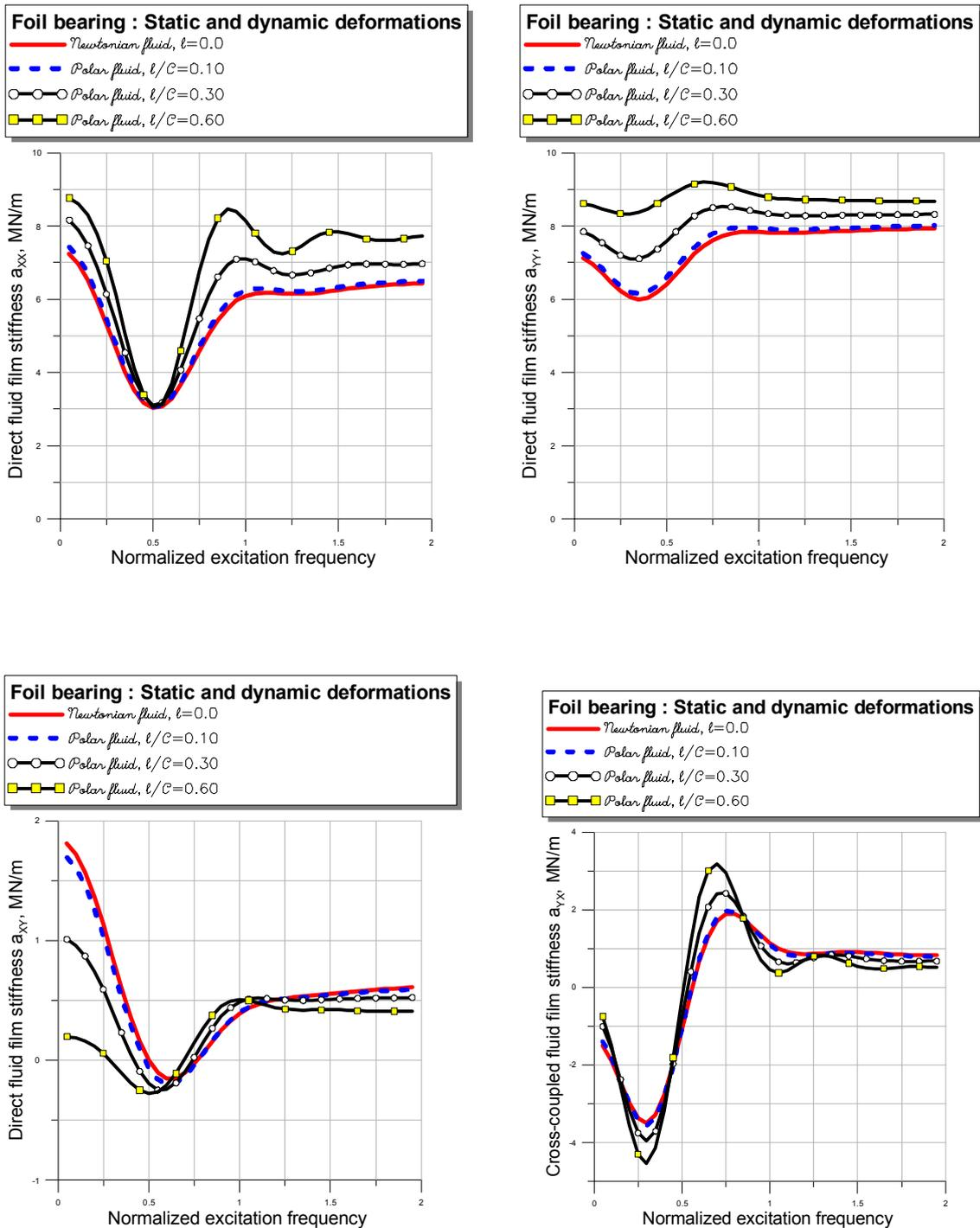
Fig. IV.10 Influence des couples de contraintes sur les coefficients de raideurs directs et indirects en cas de déformation statique et dynamique
