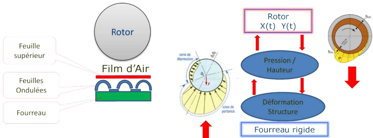
Figure I.11 Schéma de fonctionnement du palier à feuilles MITI
