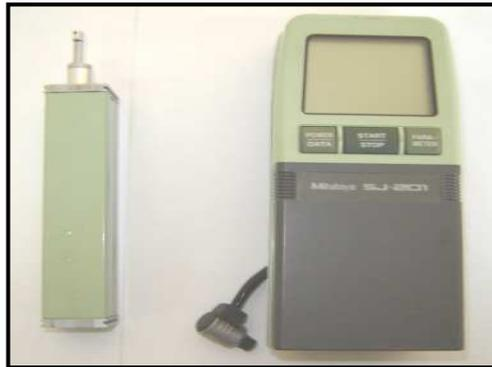
**Fig. II-11:** Rugosimètre Surf test Rj201
