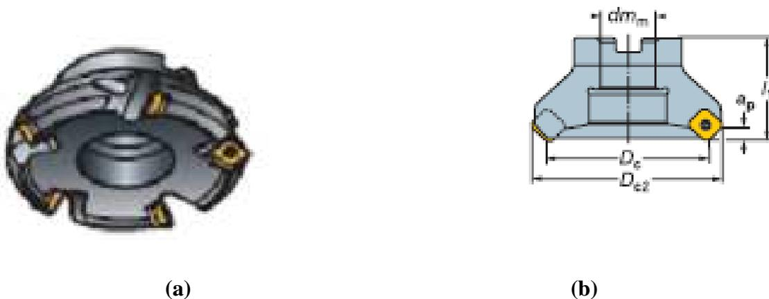
**Fig. II-8:** fraise à surfacer Coromill 245.
