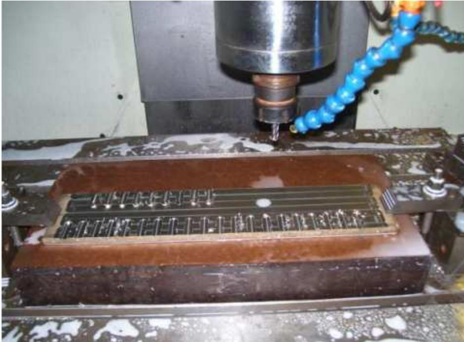
**Fig .8:** Fixation de la plaque en acier inox AISI 304 à l'aide de pinces dans le centre d'usinage [5]
