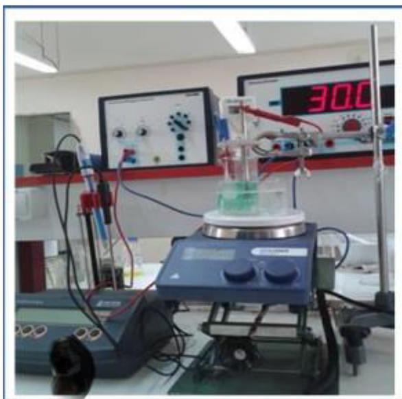
**Figure II.1:** Schéma du dispositif d'électrodéposition utilisé dans cette étude.[LAIGM]
