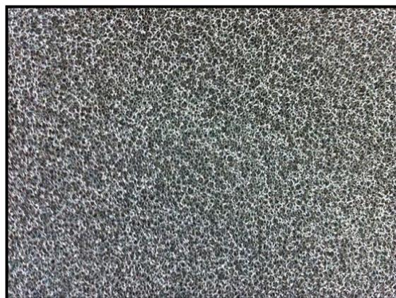
*Figure I.4: Morphologie d'une couche métallique poreuse de Nickel.[site web]*
