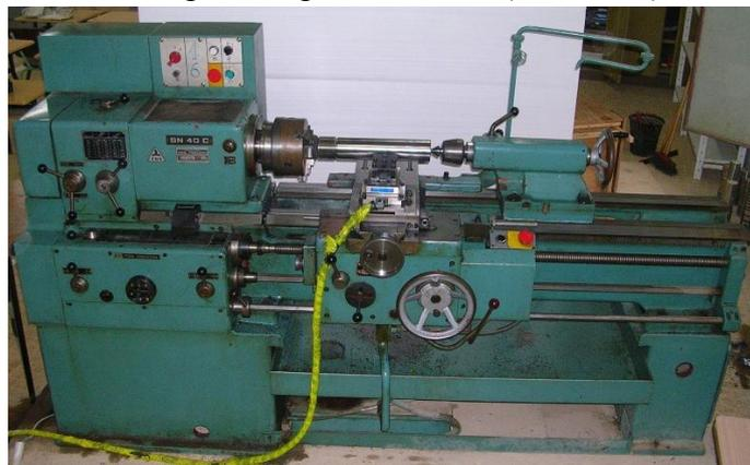
**Figure II.2** Tour parallèle modèle SN 40 C.
