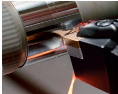
**Figure I. 16** Opération de chariotage du tournage dur (Sandvik Coromant).
