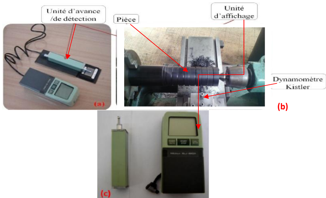
Figure II.8 : Mesure de la rugosité.
