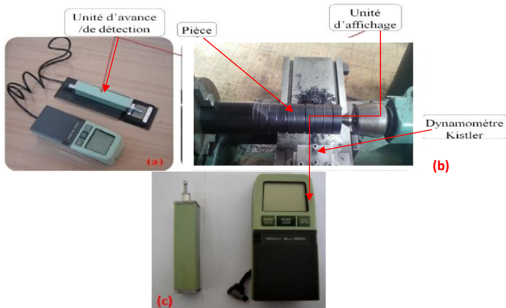
Figure II.8 : Mesure de la rugosité.
