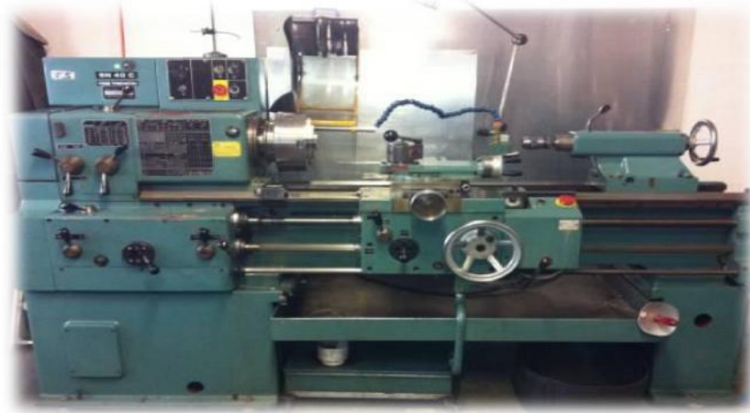
Figure II.1: Tour à charioter et à fileter modèle SN40.
