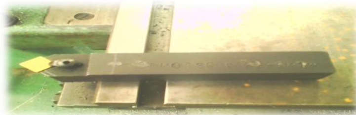
Figure II.3: Porte outil utilisé.
