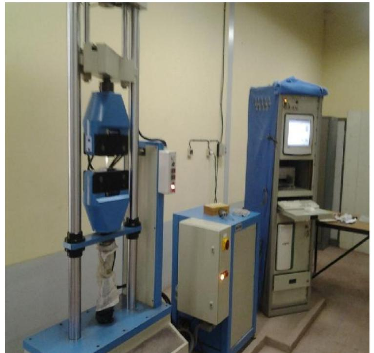
Figure III-2 : Machine de traction
