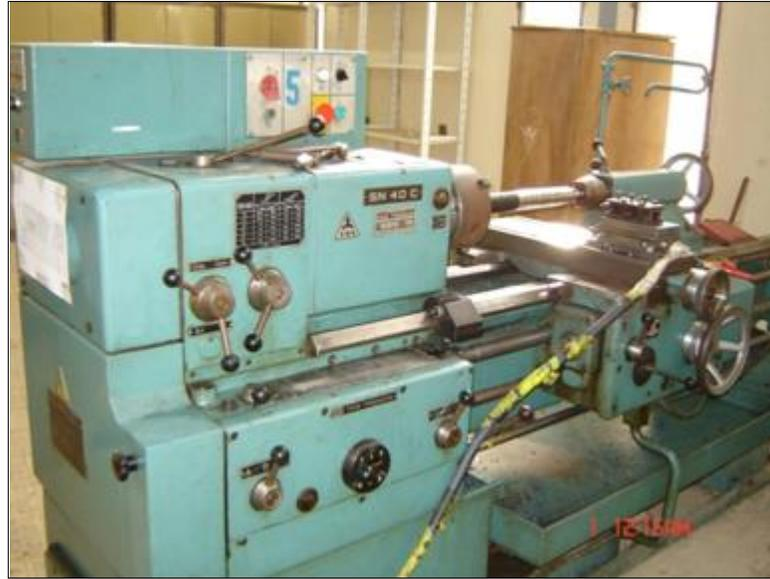
Figure II-1: Machine de Tour à charioter et à fileter modèle SN40
