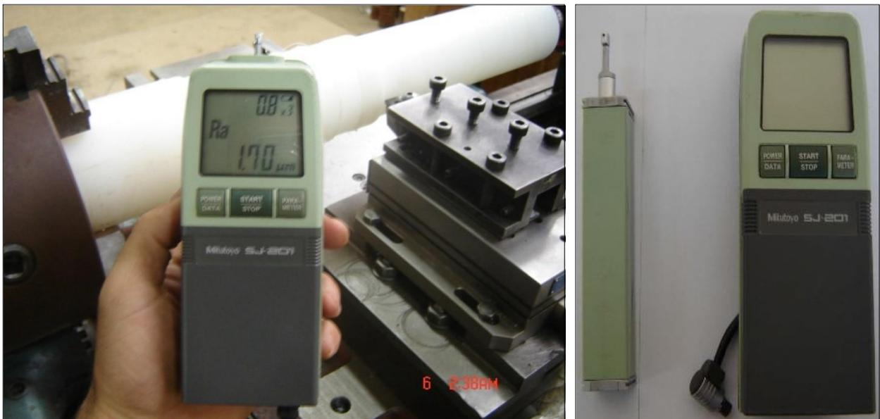
*Figure II-7: Rugosimètre pour la mesure de la rugosité SurfTest 201 (Mitutoyo)*
