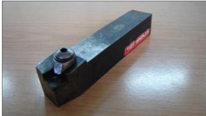
Figure II-13: Porte outil utilisé.
