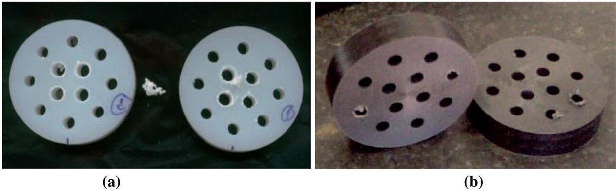
**Figure I-19:** Composantes percer pour : (a) Polyamides non renforcés (PA6), (b) Polyamides renforcés avec 30% de fibres de verre (PA66 GF30).
