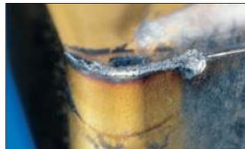
*Figure I-15: Usure en entaille*
