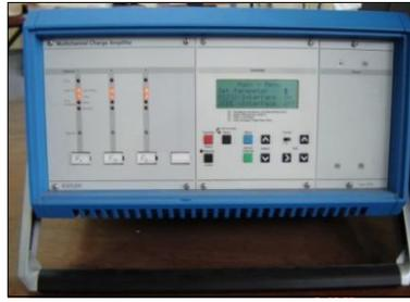
*Figure II-6: Amplificateur de la charge KISTLER*
