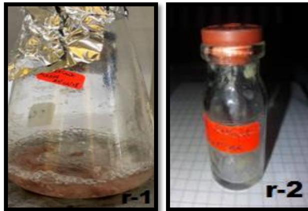
Figure 24: Résultat de l'extraction d'hexane, r-1 : macéré, r-2 : extrait brut.
